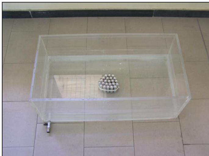
Fig. 6.2 - Vasca di calibrazione e disposizione dei trasduttori.
