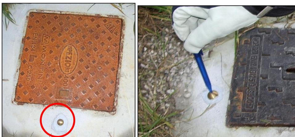
Fig. 4.2 - Esempio di posizione di vertice esterno e sua materializzazione
