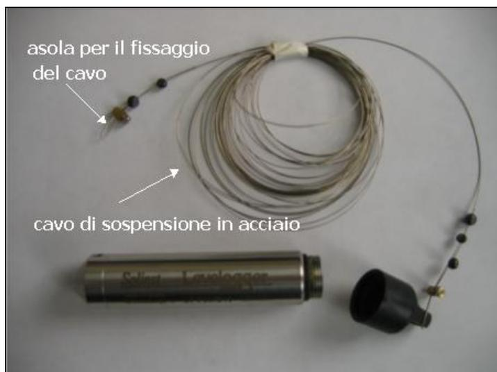
Fig. 7.1: Levellogger e cavo in acciaio di sospensione.
