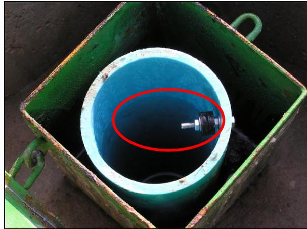
Fig. 7.2 -Vite di aggancio del cavo di sospensione del trasduttore
