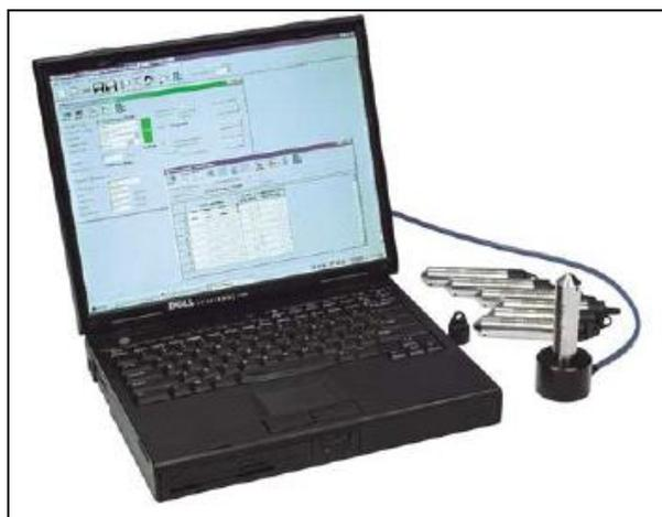
Fig. 5.5 - Operazione di download dei dati, collegamento diretto PC - trasduttore.
