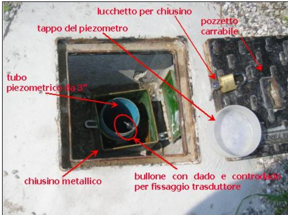
Fig. 3.3 -Dettaglio del pozzetto e del boccaforo.
