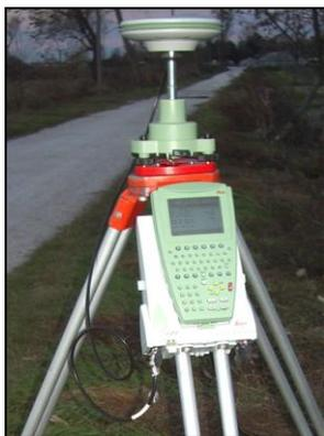
Fig. 4.4 - Ricevitore GPS doppia frequenza Leica 1200
