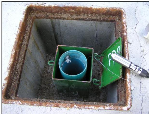
Fig. 7.3 - Postazione di monitoraggio e installazione di un Levellogger.
