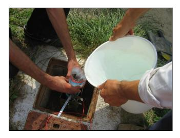
Fig.4.15 - Iniezione di un volume noto in piezometro
