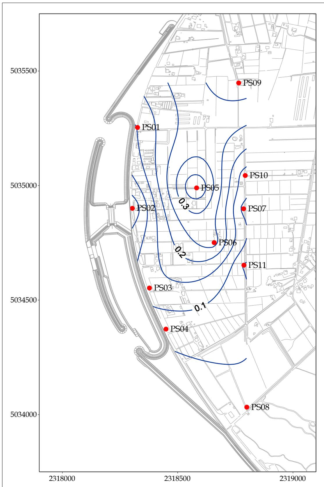
Fig. 5.5- Piezometria superficiale - giugno 2010 ( $h_t$  - m s.l.m.).
