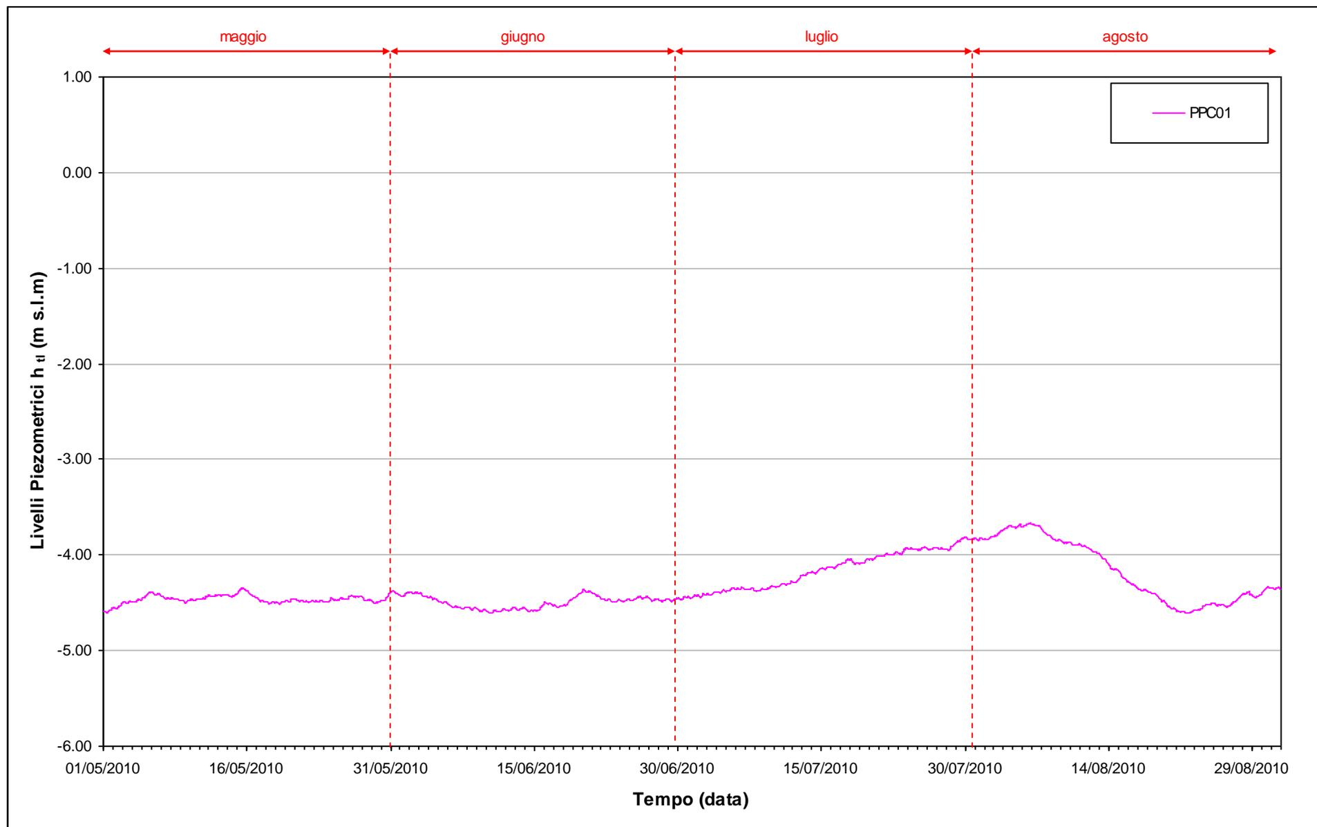
Fig. 9.10 - Livelli piezometrici ( $h_t$ ) relativi al piezometro profondo.
