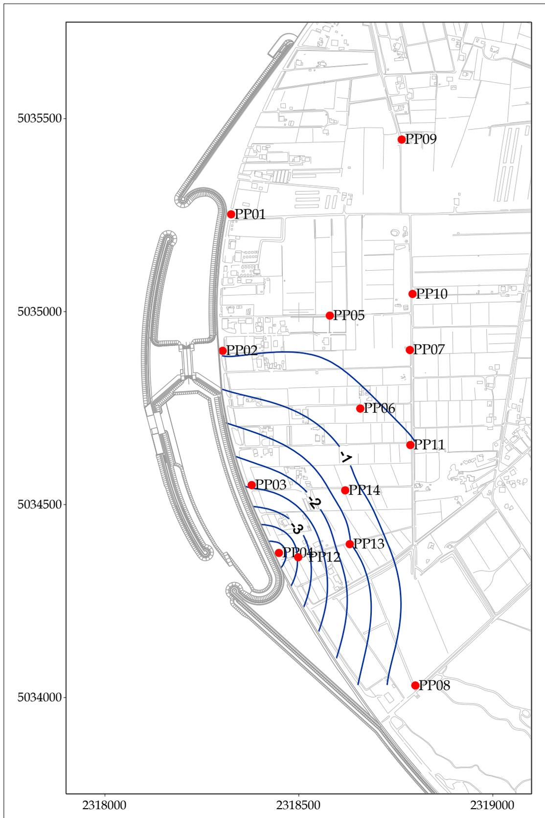
Fig. 5.11 - Piezometria profonda - luglio 2010 ( $h_u$  - m s.l.m.).
