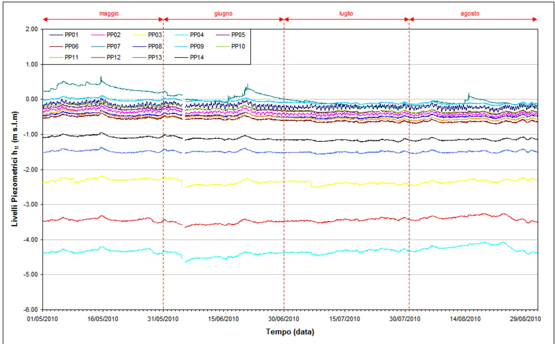
Fig. 2.11 - Livelli piezometrici ( $h_u$ ) relativi ai piezometri profondi.
