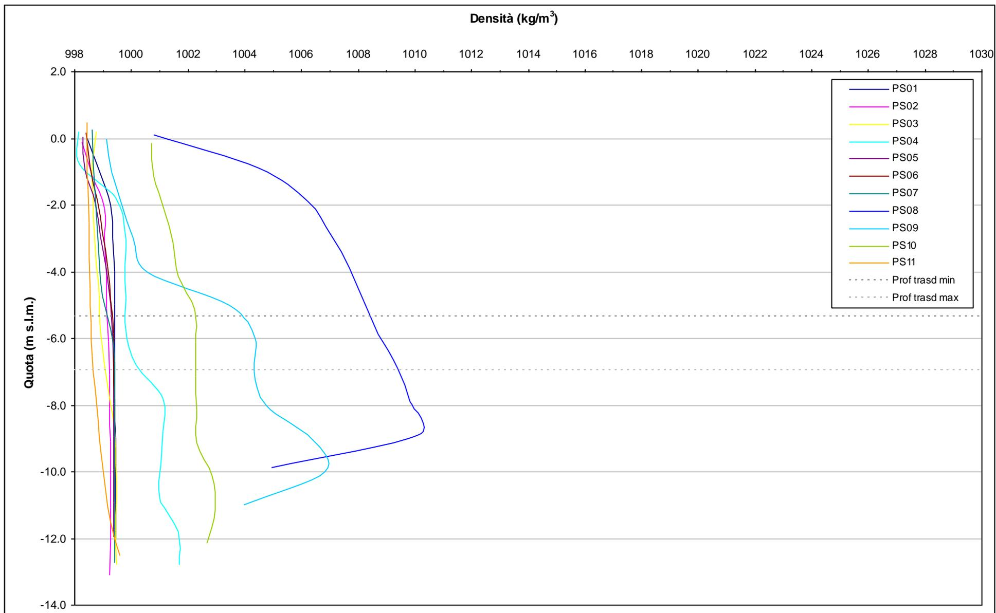
Fig. 4.4 - Profili verticali di densità piezometri superficiali - 6-8 settembre 2010.
