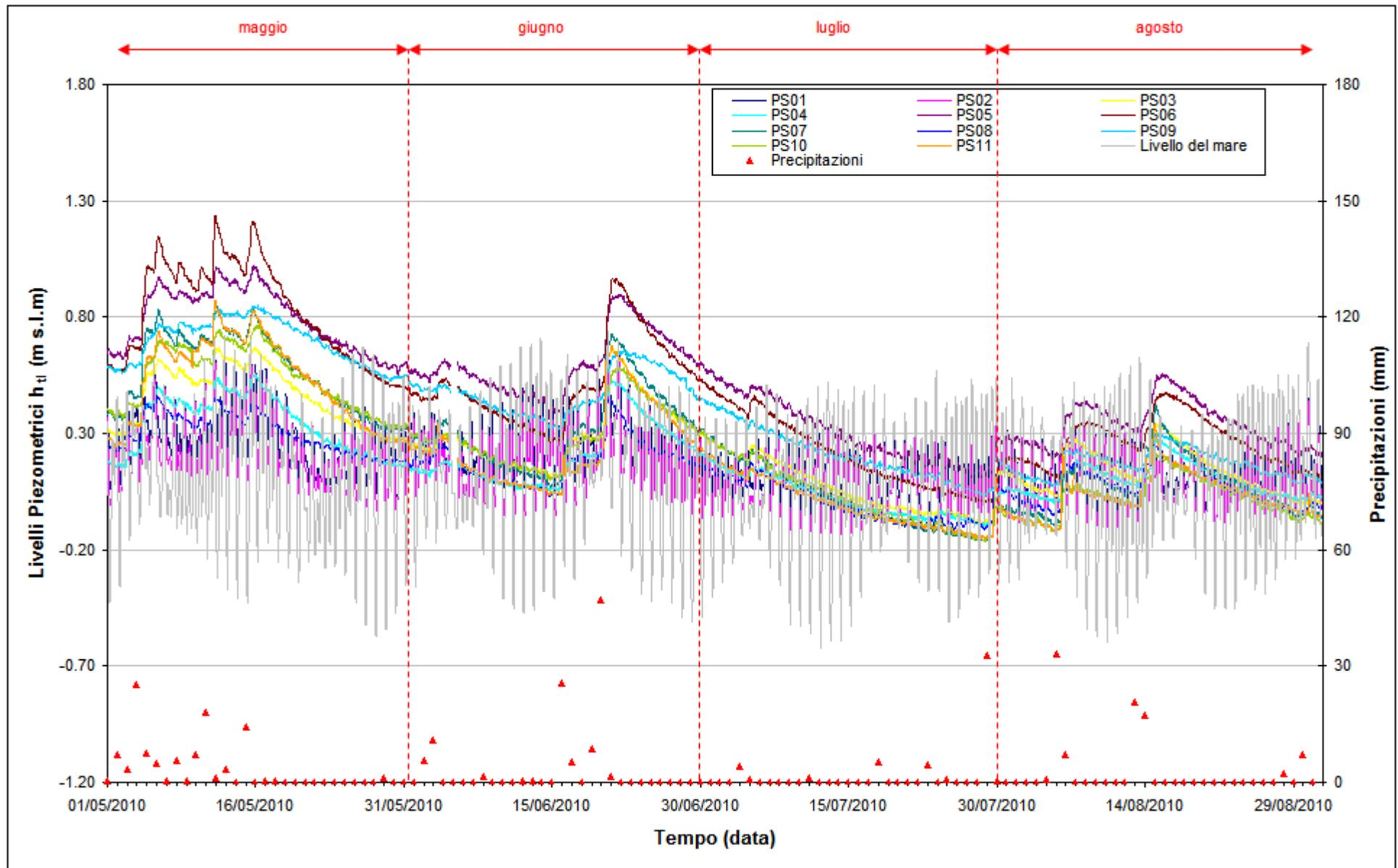
Fig. 2.6 - Livelli piezometrici ( $h_U$ ) relativi ai piezometri superficiali nel periodo di monitoraggio 01/05/2010 - 31/08/2010.
