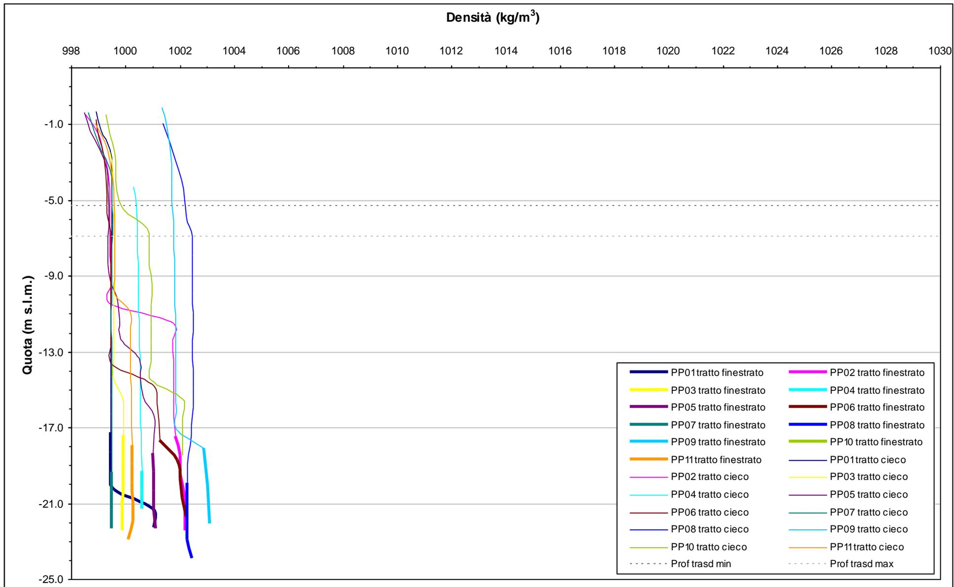
Fig. 4.7 - Profili verticali di densità piezometri profondi - 28-29 luglio 2010.
