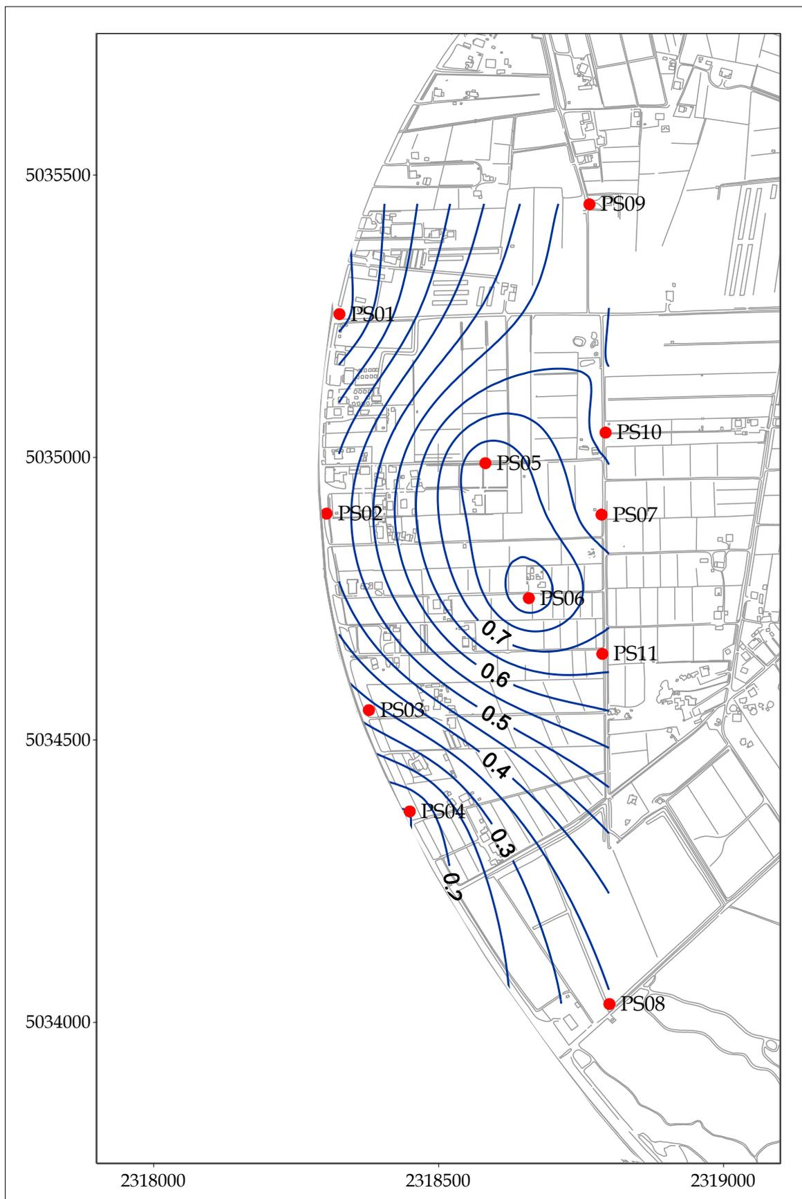
Fig. 5.3 - Piezometri superficiale Fase A - novembre 2005 (h<sub>il</sub> - m s.l.m.).
