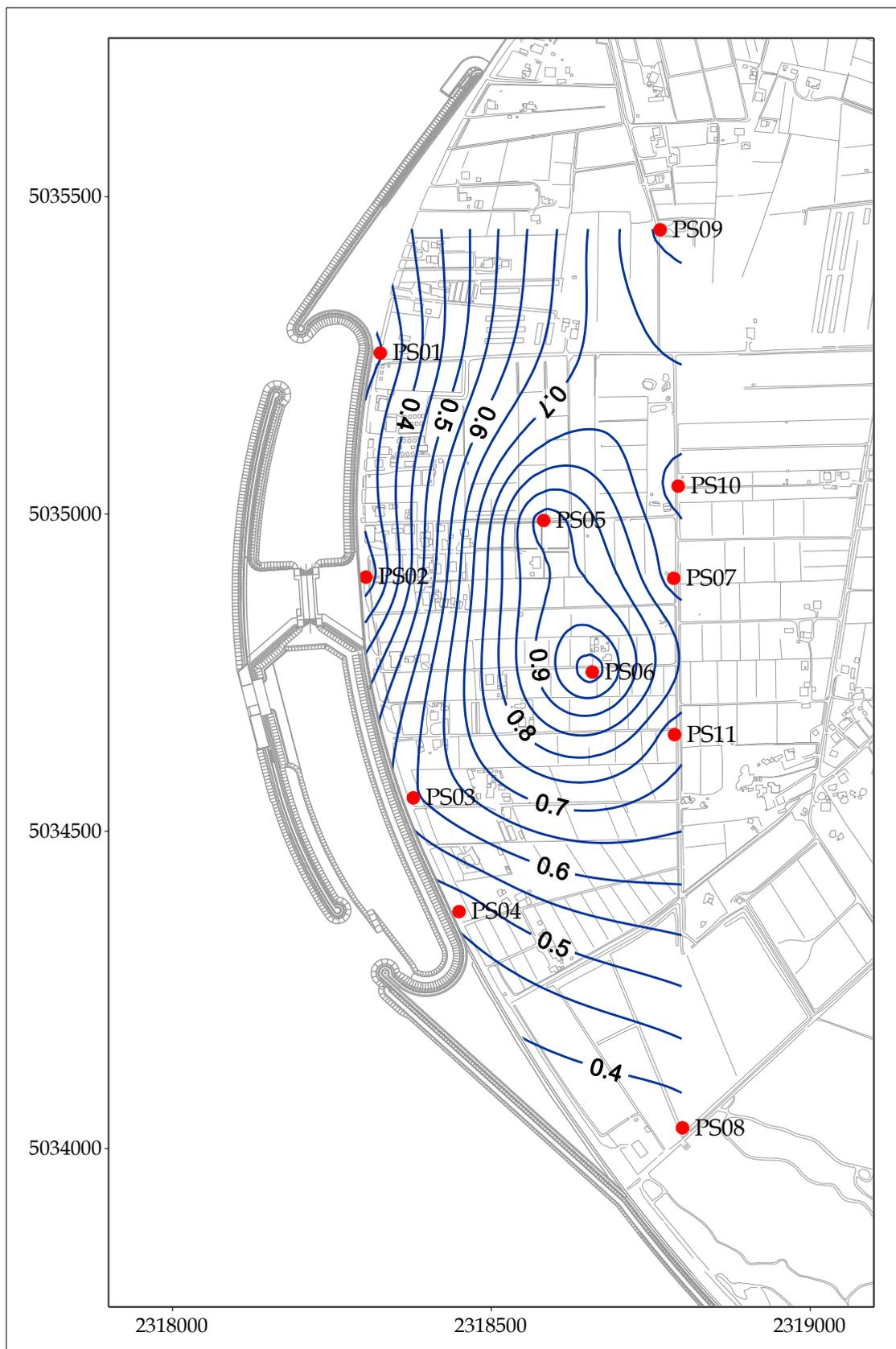
Fig. 5.4 - Piezometria superficiale - maggio 2010 ( $h_u$  - m s.l.m.).
