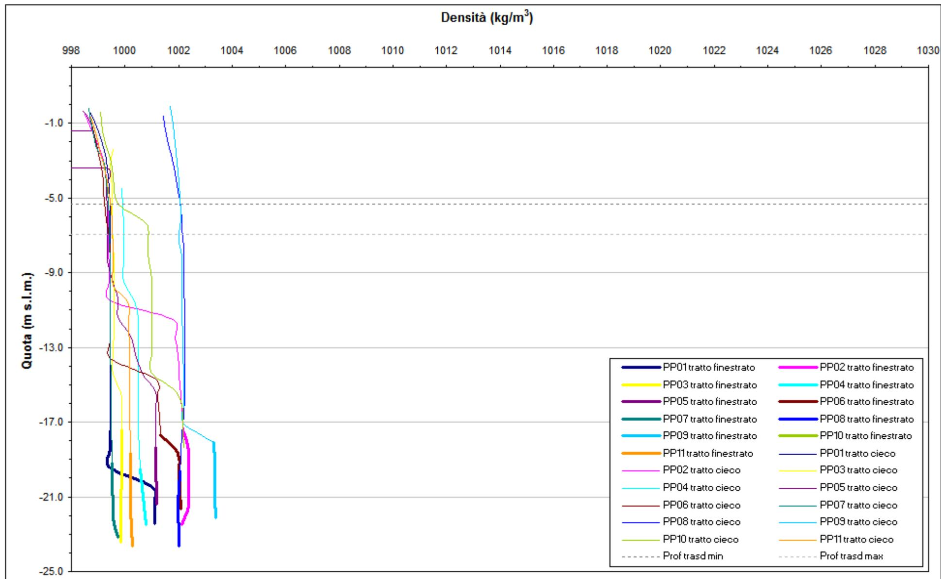
Fig. 4.8 - Profili verticali di densità piezometri profondi - 6-8 settembre 2010.
