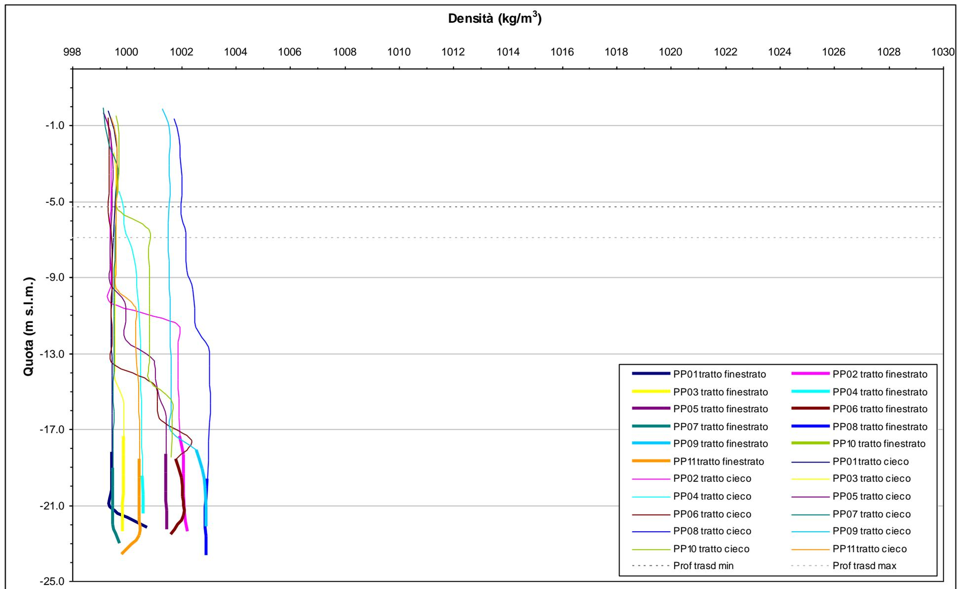
Fig. 4.5 - Profili verticali di densità piezometri profondi - 4 giugno 2010.
