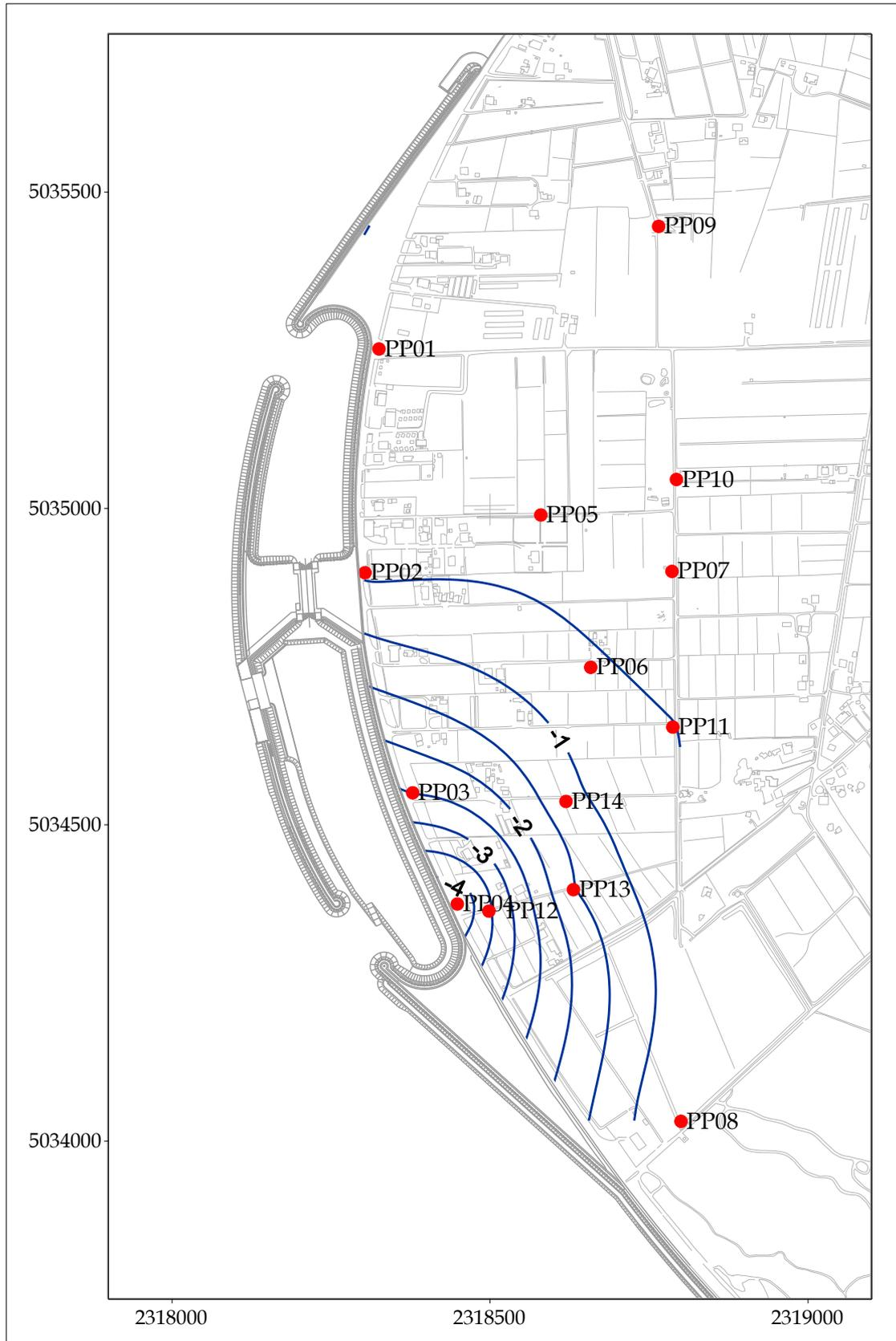
Fig. 5.10 - Piezometria profonda - giugno 2010 ( $h_{d1}$  - m s.l.m.).
