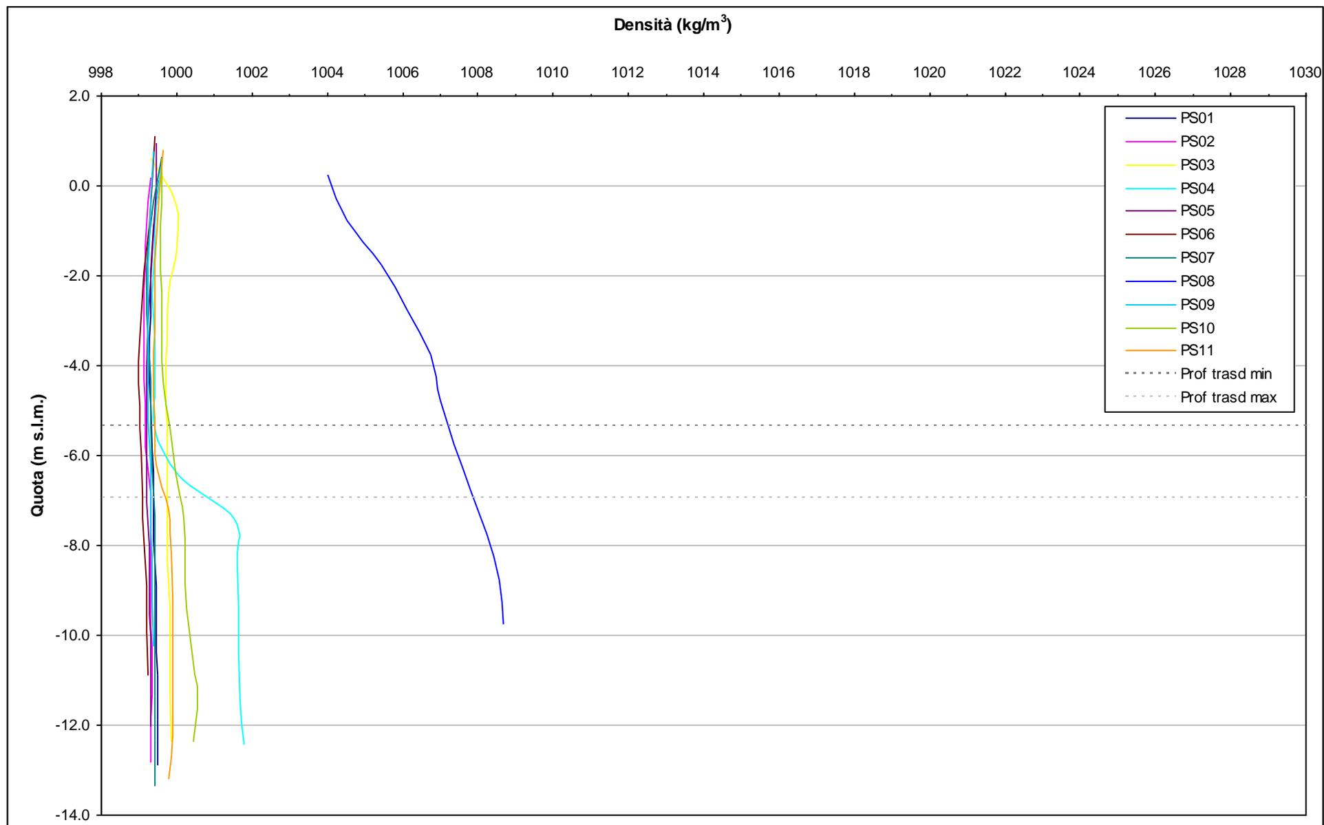
Fig. 4.3 - Profili verticali di densità piezometri superficiali - 28-29 luglio 2010.
