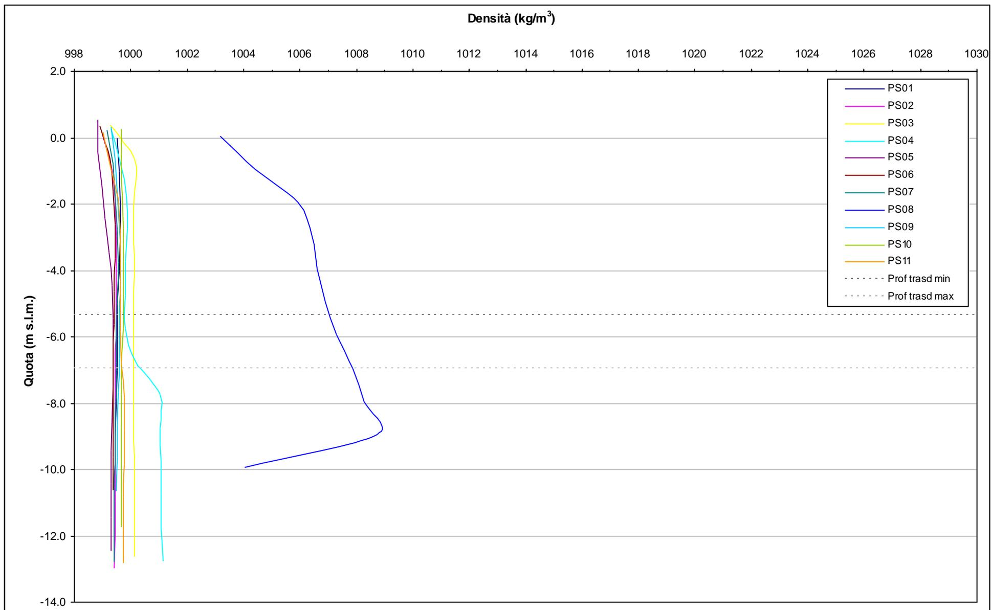
Fig. 4.1- Profili verticali di densità piezometri superficiali - 4 giugno 2010.
