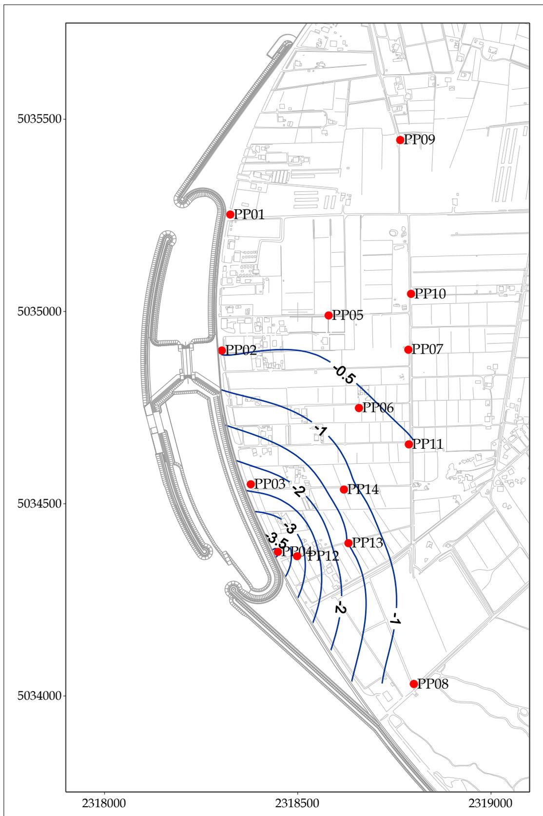
Fig. 5.12 - Piezometria profonda - agosto 2010 ( $h_{fl}$  - m s.l.m.).
