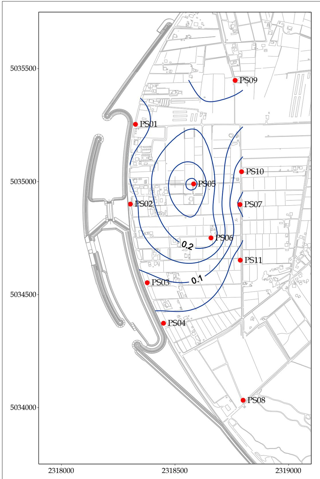
Fig. 5.6 - Piezometria superficiale - luglio 2010 ( $h_{fl}$  - m s.l.m.).
