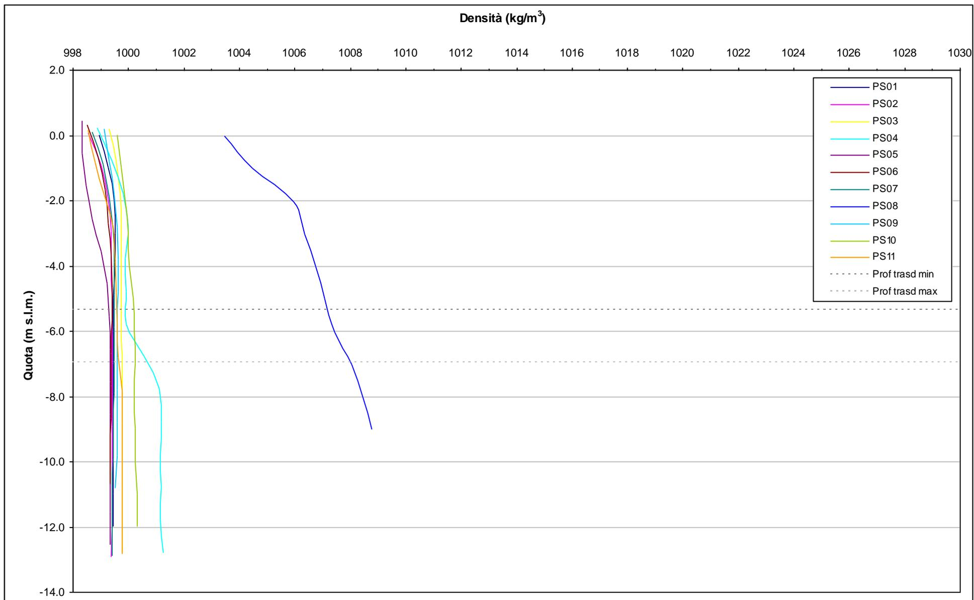
Fig. 4.2- Profili verticali di densità piezometri superficiali - 6 luglio 2010.
