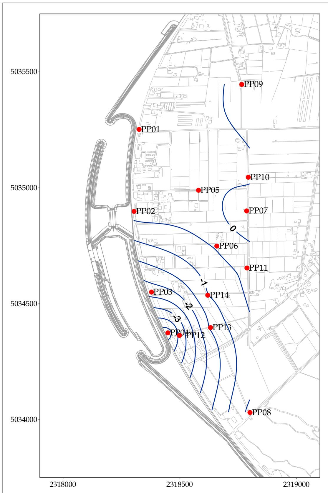
Fig. 5.9 - Piezometria profonda - maggio 2010 (h<sub>fl</sub> - m s.l.m.).
