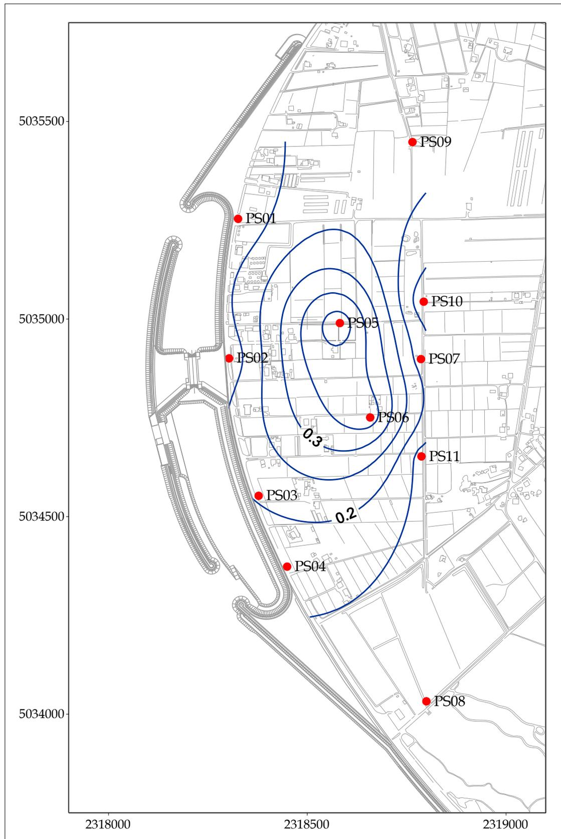
Fig. 5.7 - Piezometria superficiale - agosto 2010 ( $h_t$  - m s.l.m.).
