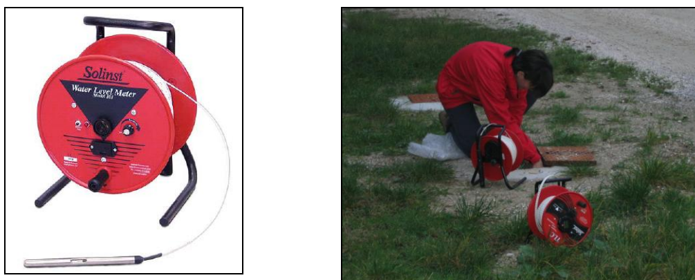
Fig.3.14 - Sondino piezometrico (freatimetro), Solinst Model 101 WL Meter 80 ed operazione di misura manuale della soggiacenza.
