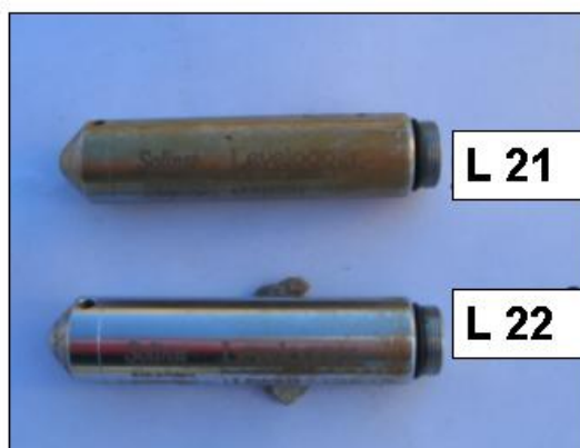
Fig.2.3 - Tracce di ossidazione rilevate su alcuni trasduttori
