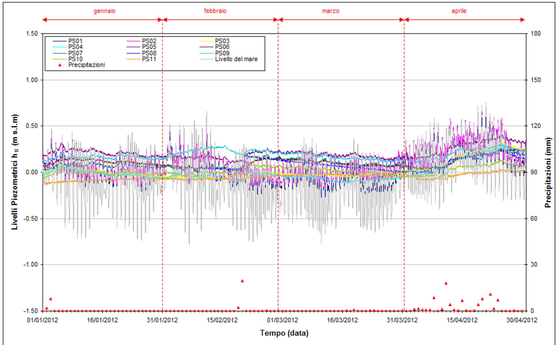
Fig. 2.7 - Livelli piezometrici ( $h_u$ ) relativi ai piezometri superficiali nel periodo di monitoraggio 01/01/2012 - 30/04/2012.
