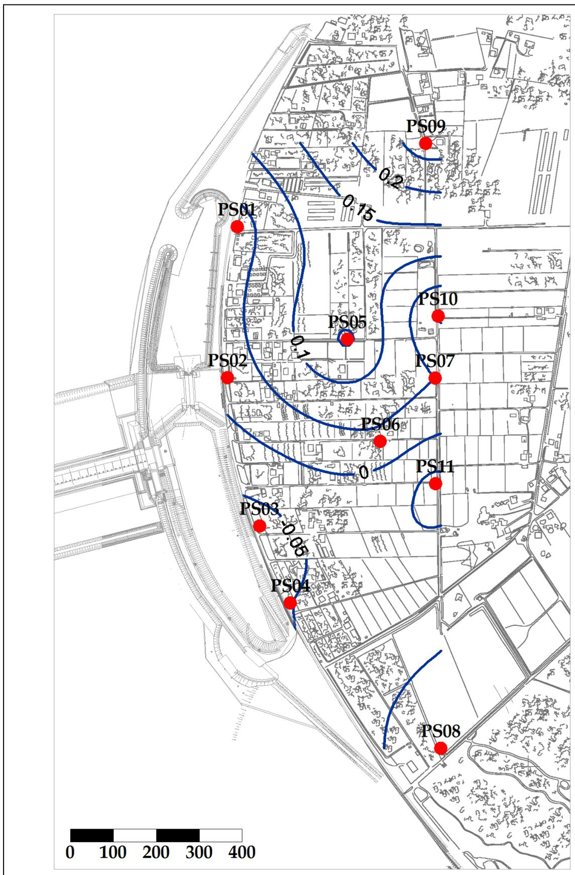
Fig. 5.5- Piezometria superficiale - febbraio 2012 ( $h_H$  - m s.l.m.).
