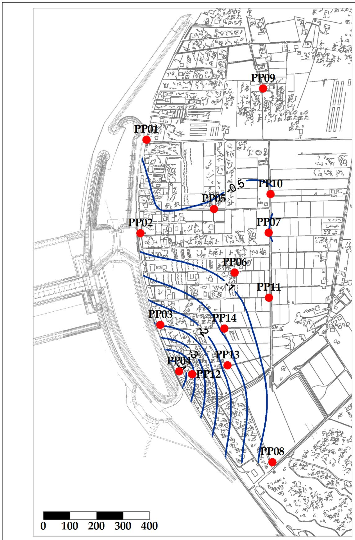
Fig. 5.9 - Piezometria profonda - gennaio 2012 (h<sub>l</sub> - m s.l.m.).
