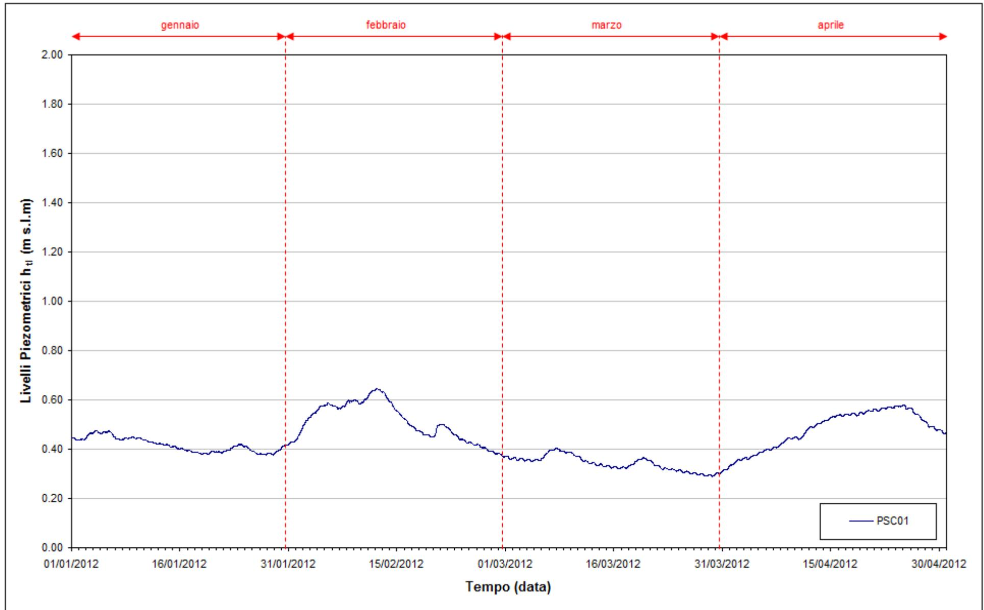
Fig. 9.7- Livelli piezometrici ( $h_t$ ) relativi al piezometro superficiale nel quadrimestre di monitoraggio.
