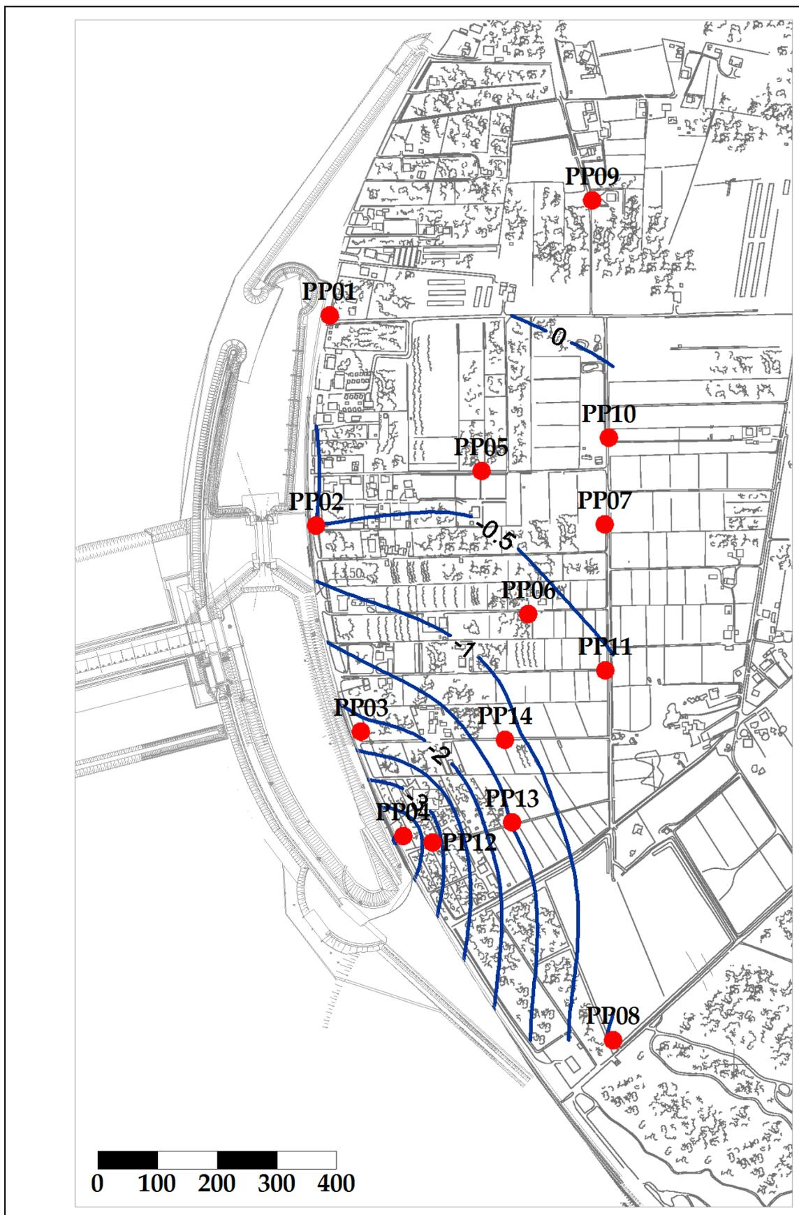
Fig. 5.10 - Piezometria profonda - febbraio 2012 ( $h_{PI}$  - m s.l.m.).
