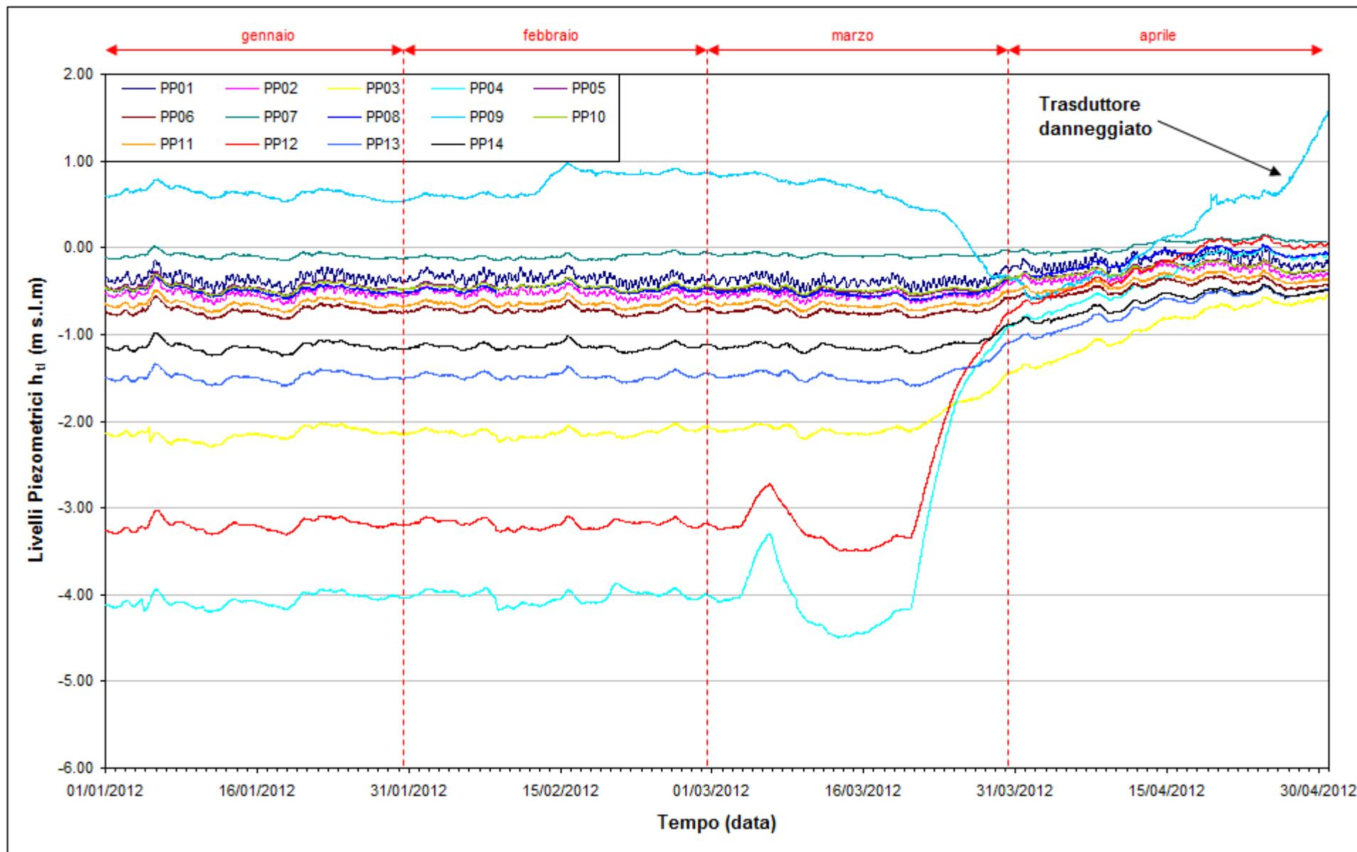
Fig. 2.12 - Livelli piezometrici ( $h_u$ ) relativi ai piezometri profondi.
