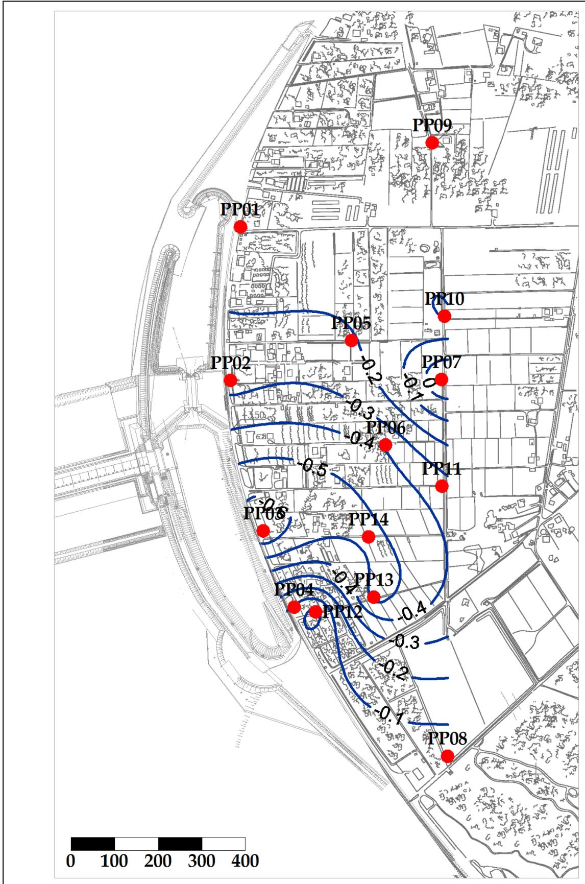
Fig. 5.12 - Piezometria profonda - aprile 2012 ( $h_u$  - m s.l.m.).
