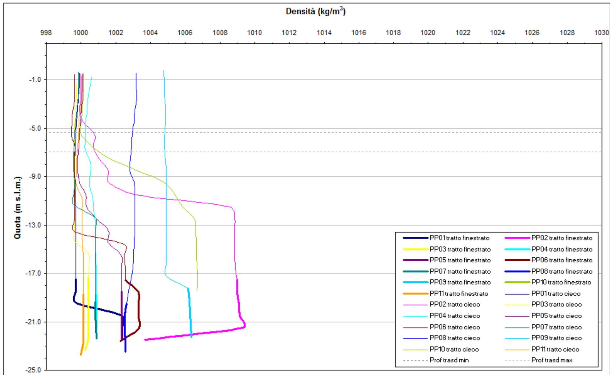
Fig. 4.7 - Profili verticali di densità piezometri profondi - 3 aprile 2012.
