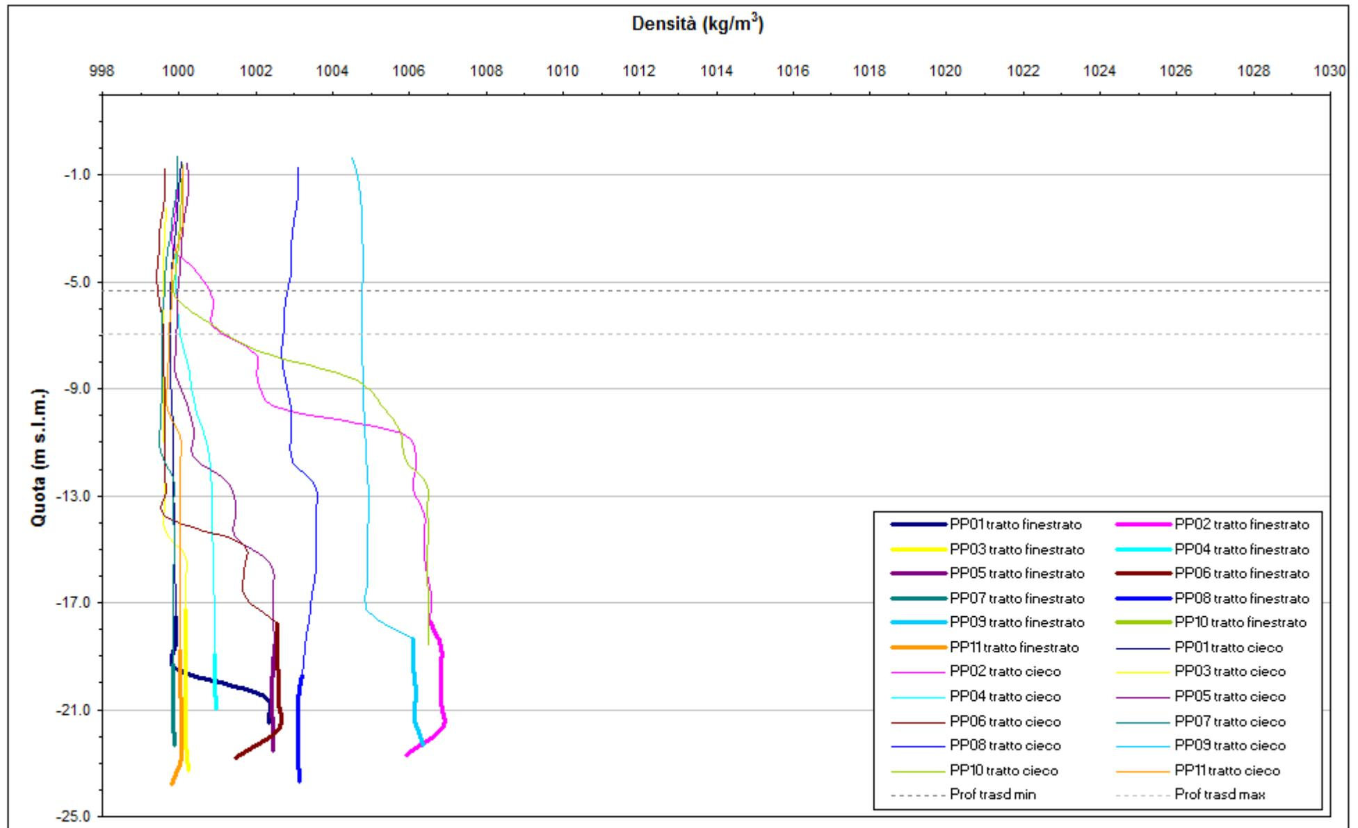
Fig. 4.6- Profili verticali di densità piezometri profondi - 8-9 marzo 2012.
