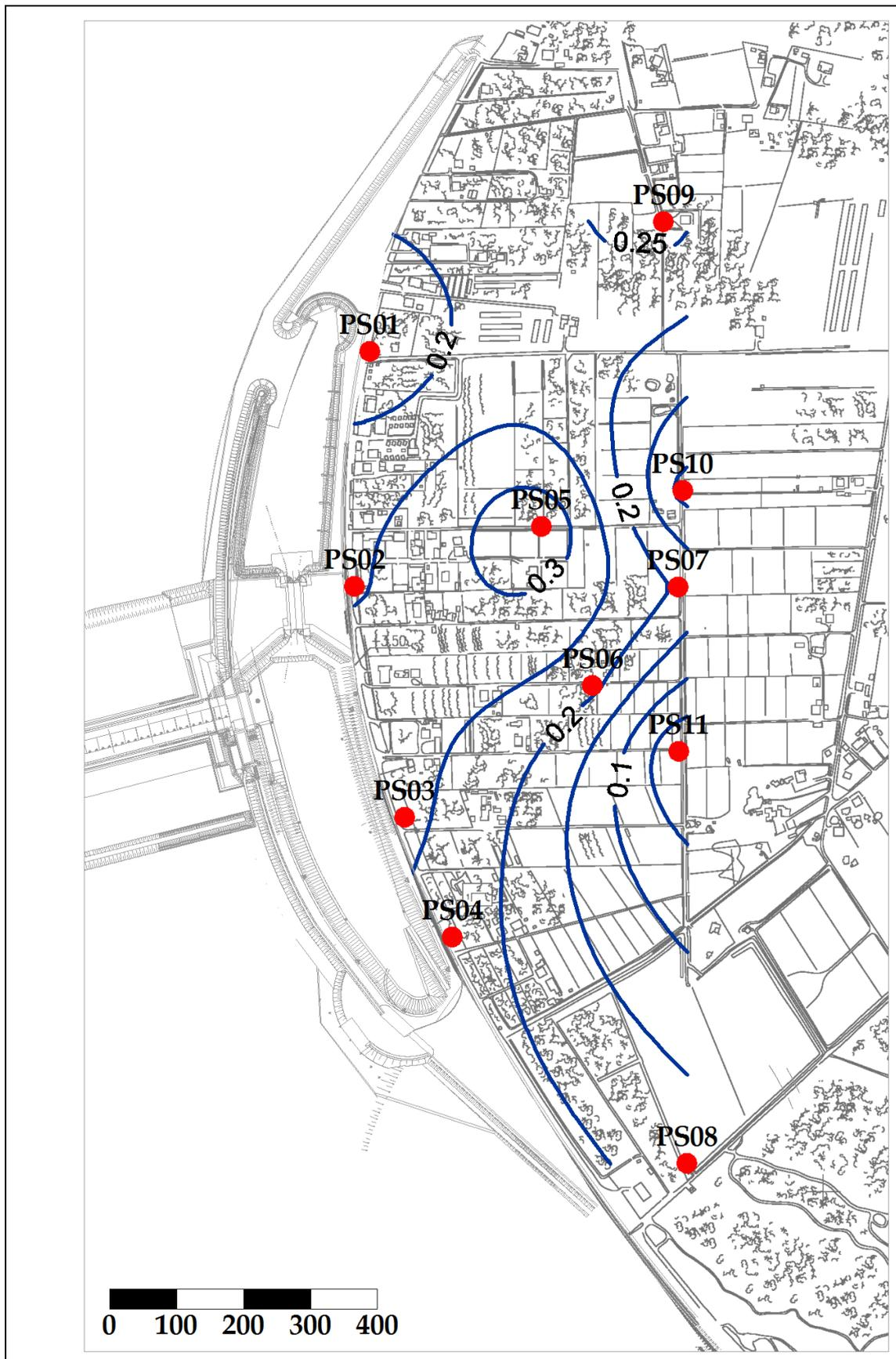
Fig. 5.7 - Piezometria superficiale - aprile 2012 ( $h_H$  - m s.l.m.).
