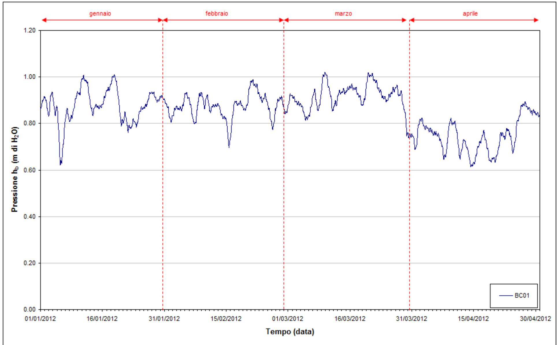
Fig. 9.5- Tracciato di misura del Barologger BC01 ( $h_b$ ).
