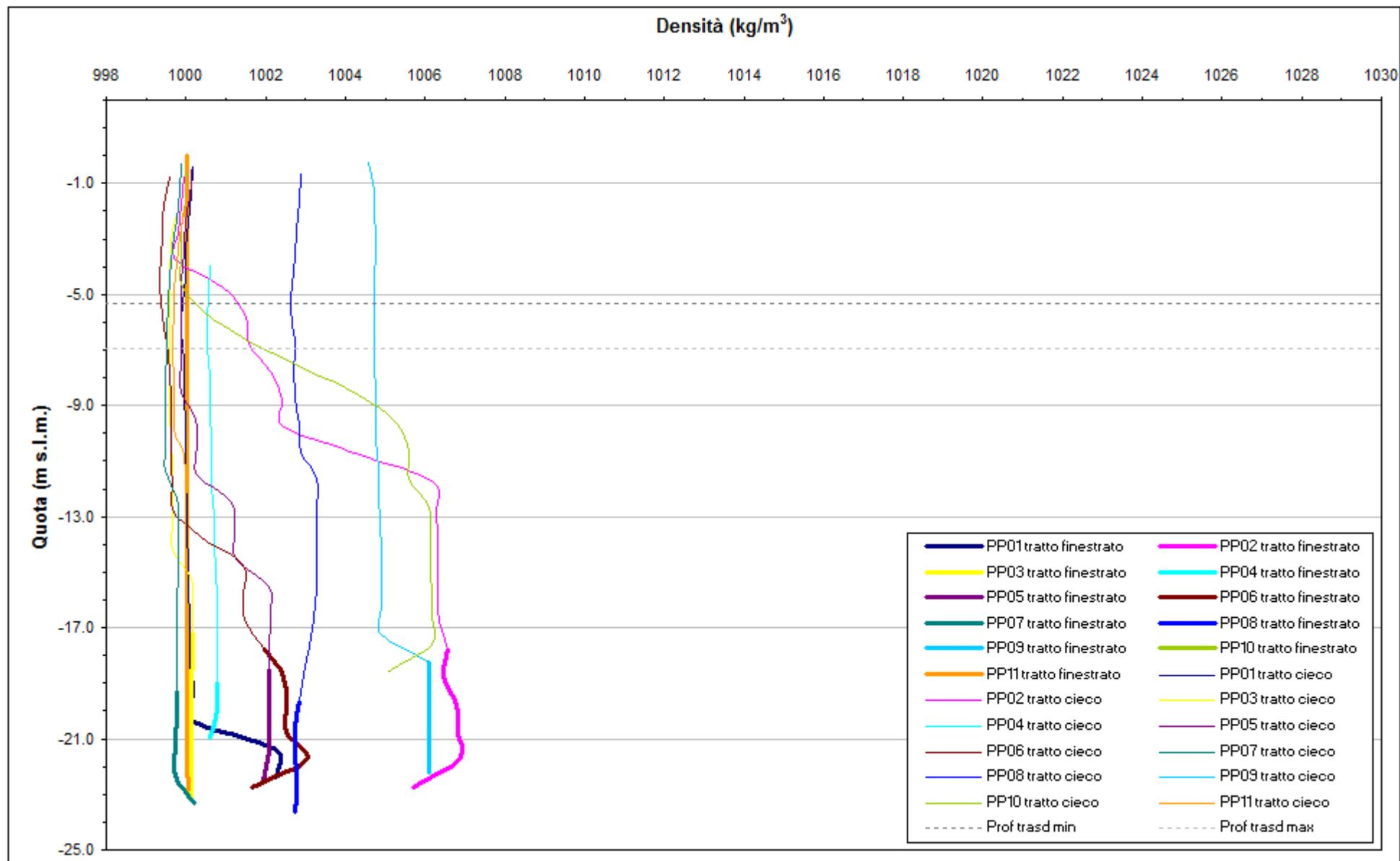
Fig. 4.5 - Profili verticali di densità piezometri profondi - 7-8 febbraio 2012.
