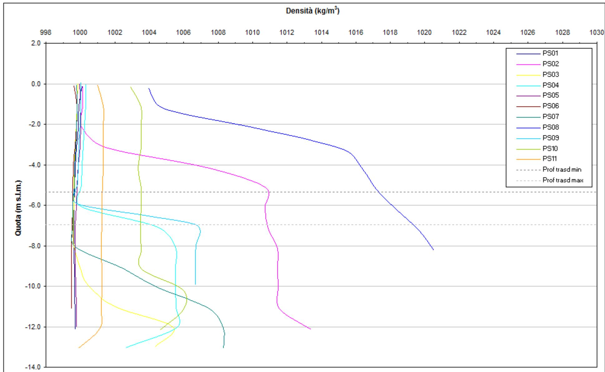
Fig. 4.3 - Profili verticali di densità piezometri superficiali - 3 aprile 2012.
