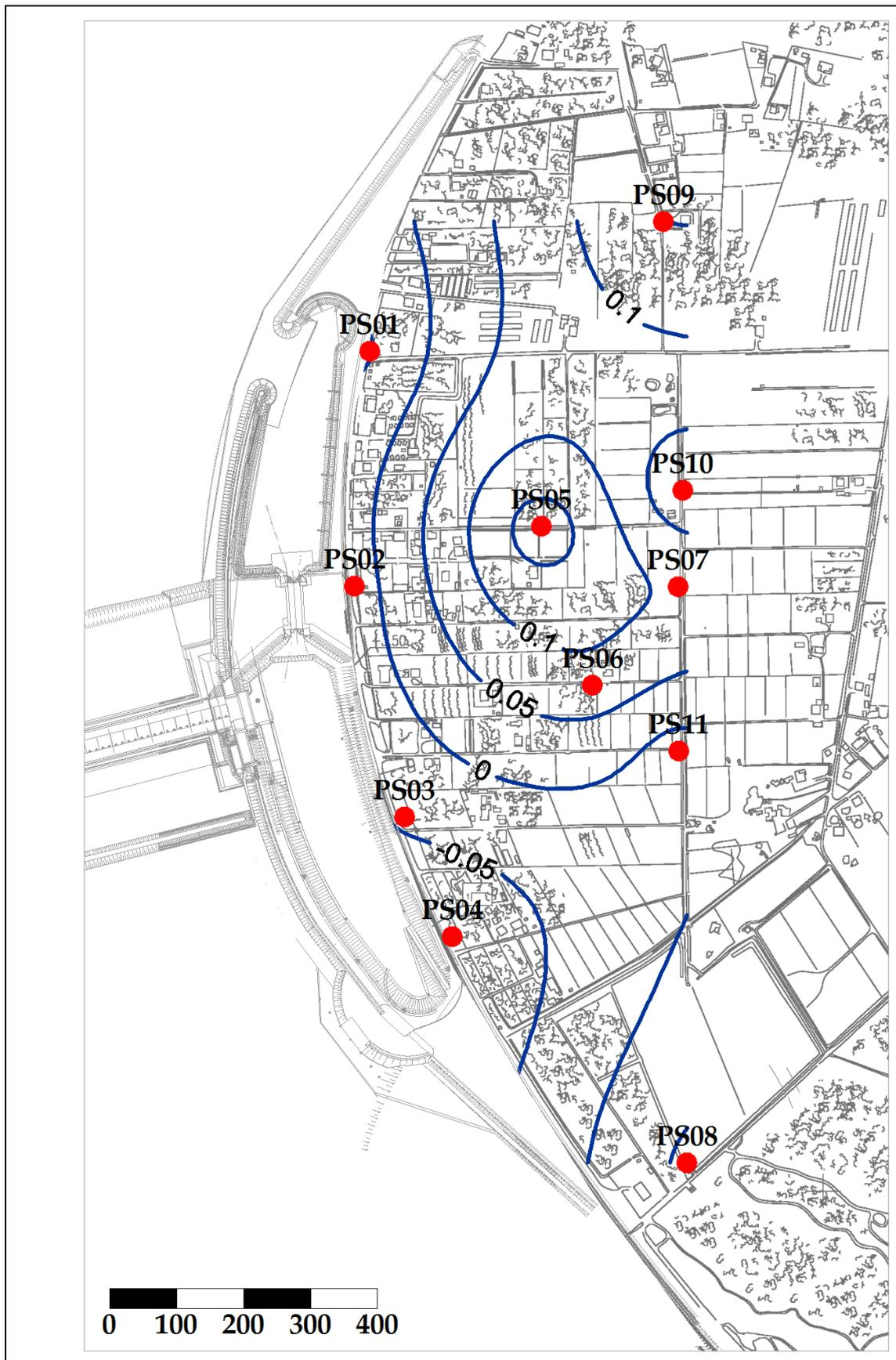
Fig. 5.6 - Piezometria superficiale - marzo 2012 ( $h_{el}$  - m s.l.m.).
