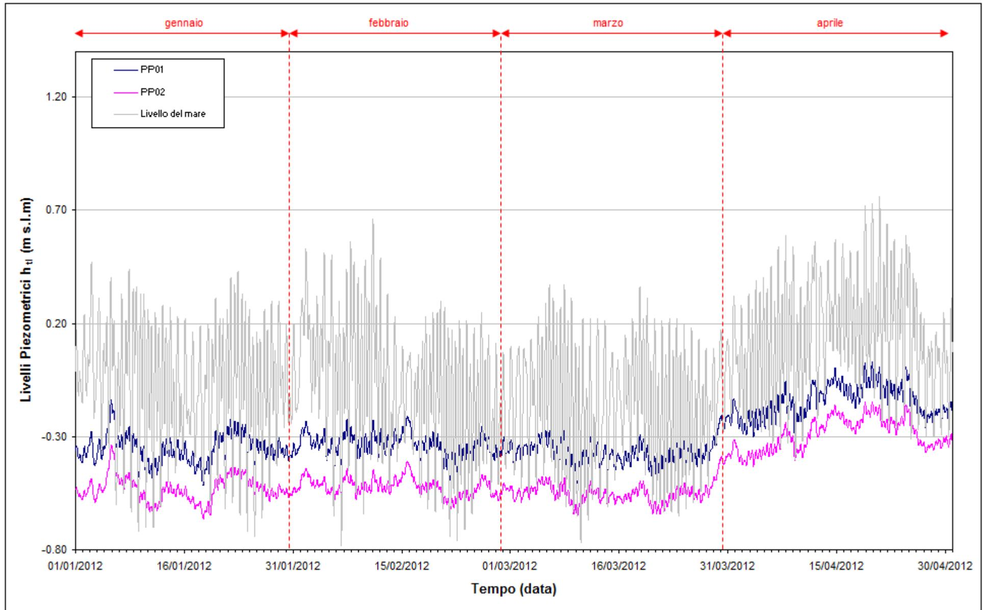
Fig. 2.13- Livelli piezometrici dei piezometri profondi PP01, PP02 e livelli del mare.
