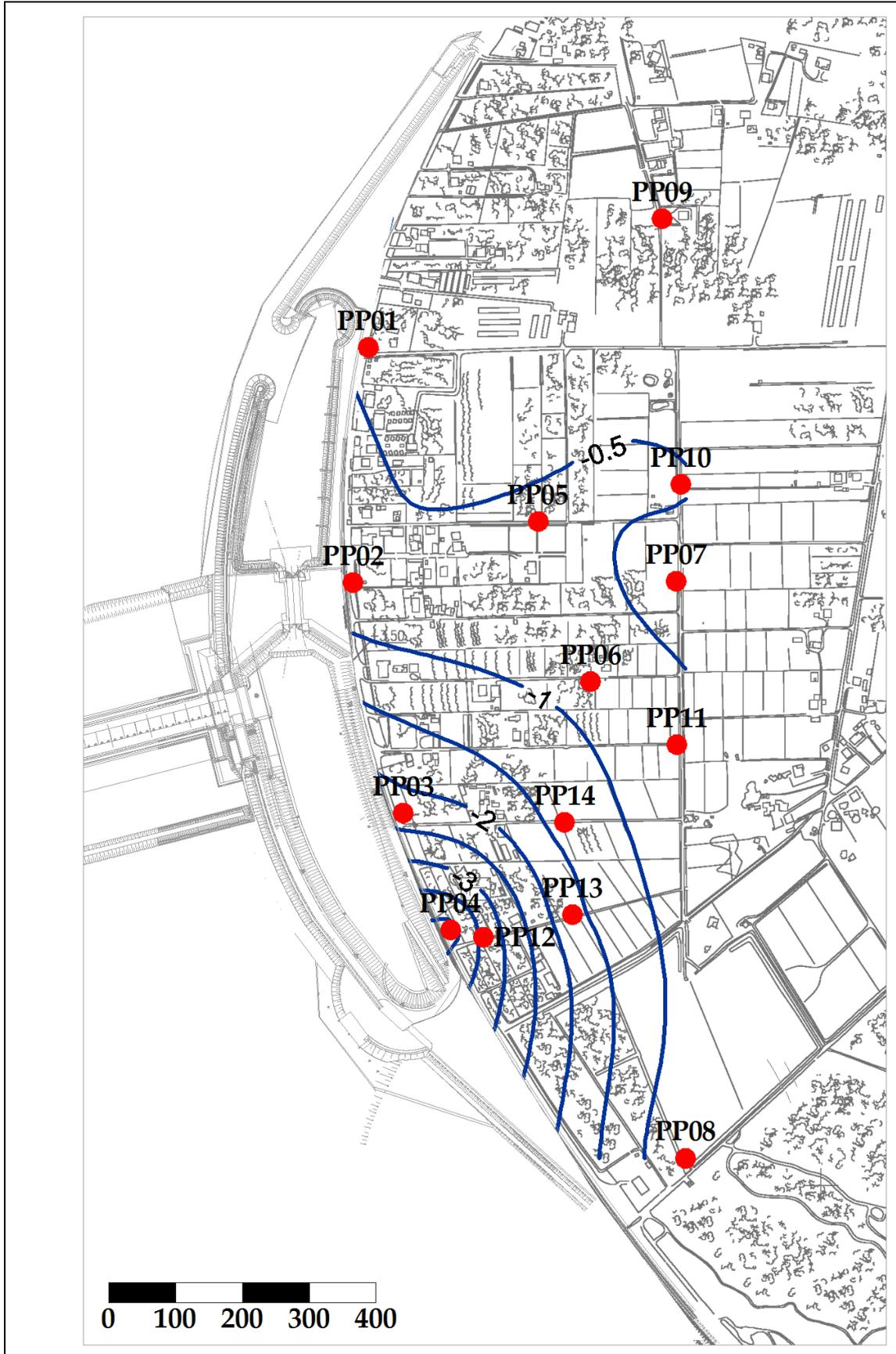
Fig. 5.11 - Piezometria profonda - marzo 2012 ( $h_H$  - m s.l.m.).
