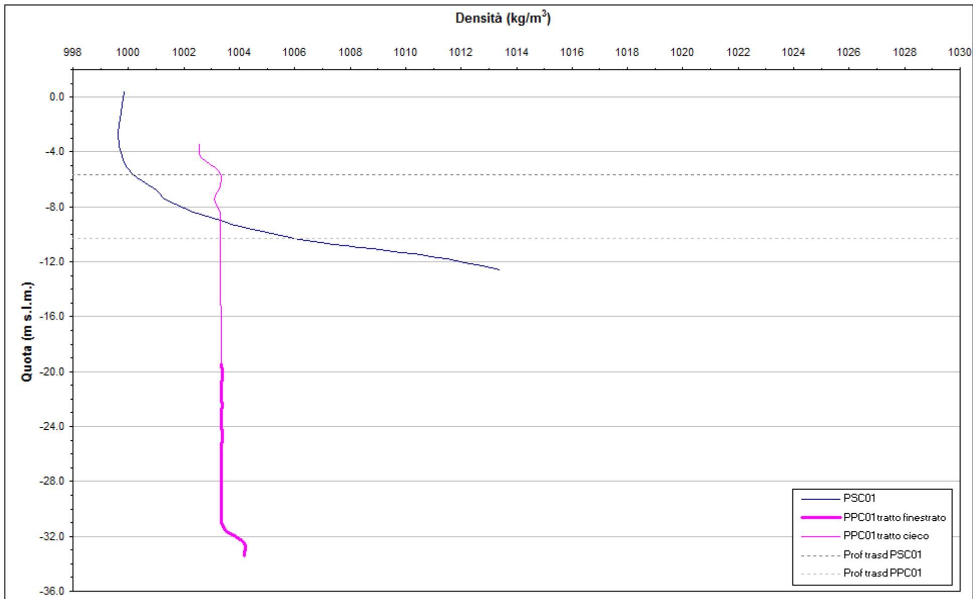
Fig. 11.1 Profili verticali di densità - 8 febbraio 2012.
