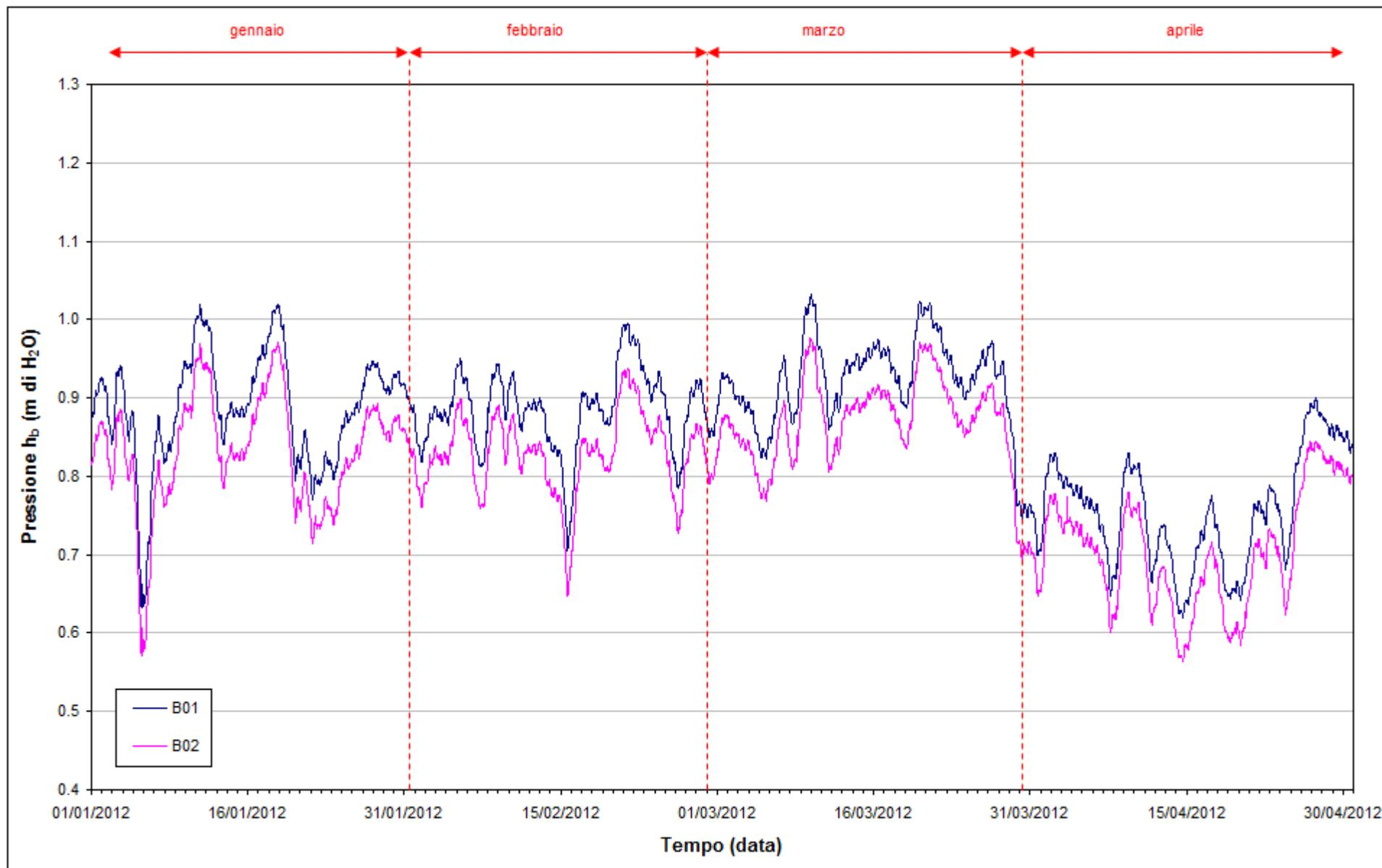
Fig. 2.6 - Tracciati di misura dei Barologger B01 e B02 ( $h_b$ ).
