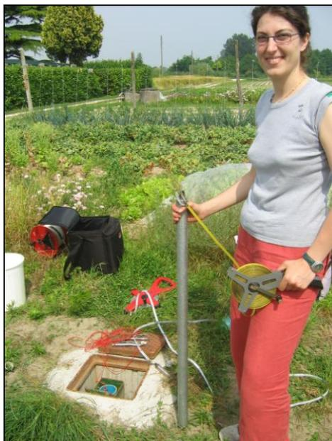
Fig.4.13- Attrezzatura utilizzata per l'esecuzione dello slug test
