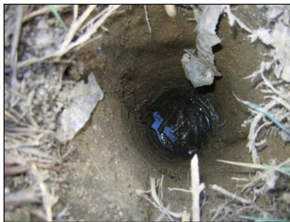
Fig. 4.8 – Presenza di acqua al fondo del pozzetto PZ1
