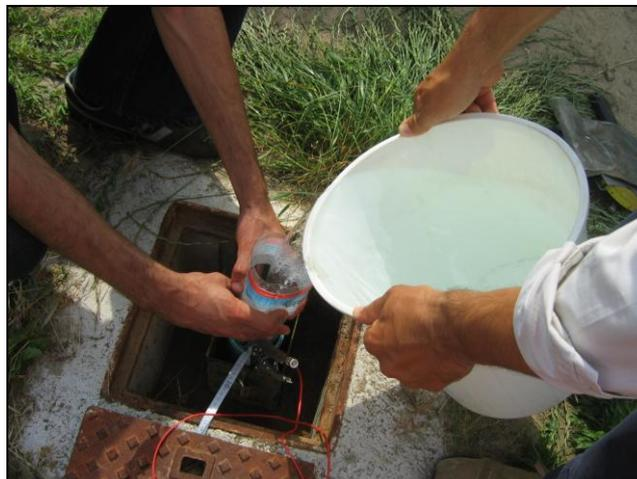
Fig.4.15 - Iniezione di un volume noto in piezometro
