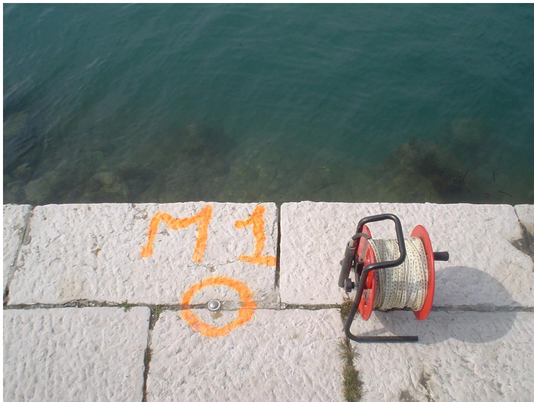
Fig.2. 2 - Punto di livellamento M1
