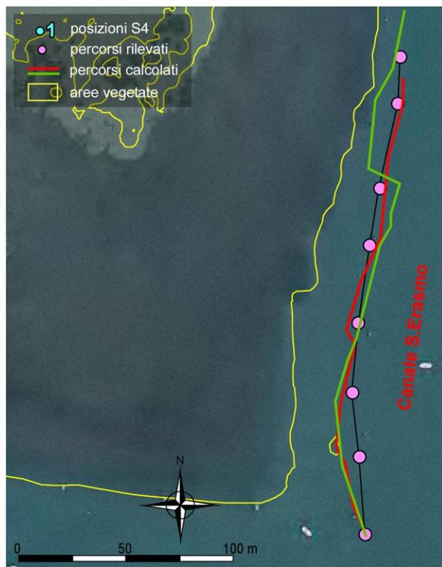
Figura 39 - Bocca di Lido. Confronto tra il percorso rilevato per una delle droghe rilasciate durante la campagna di rilievi del 12-13 febbraio 2013 e le traiettorie percorse da due particelle in sospensione calcolate con il modello lagrangiano.
