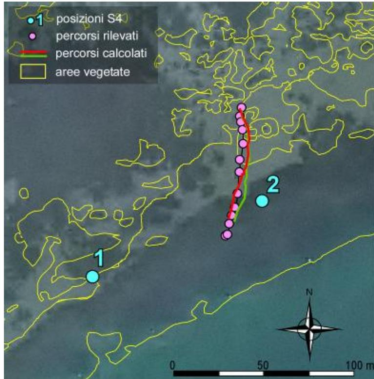
Figura 28 - Bocca di Lido. Confronto tra il percorso rilevato per la droga 1 durante la campagna di rilievi del 22 dicembre 2011 e le traiettorie percorse da due particelle in sospensione calcolate con il modello lagrangiano.
