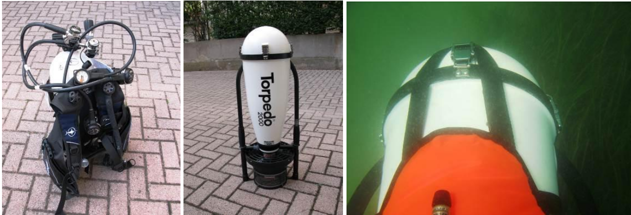
Figura 3.25 - Attrezzatura subacquea impiegata nei rilievi del margine della prateria: a sinistra equipaggiamento standard FIPSAS composto da una bombola, jacket, due erogatori e un manometro; al centro e a destra veicolo elettrico per il trascinamento dei subacquei.
