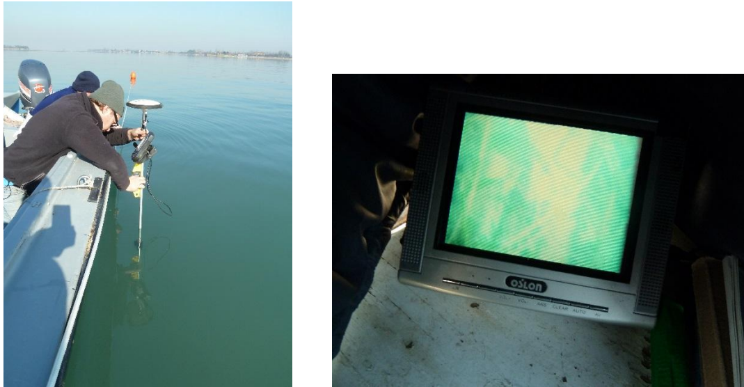
Figura 15. Rilievo stop&go da imbarcazione (sinistra) e immagine a videoterminale rilevata dalla telecamera subacquea al fondo.
