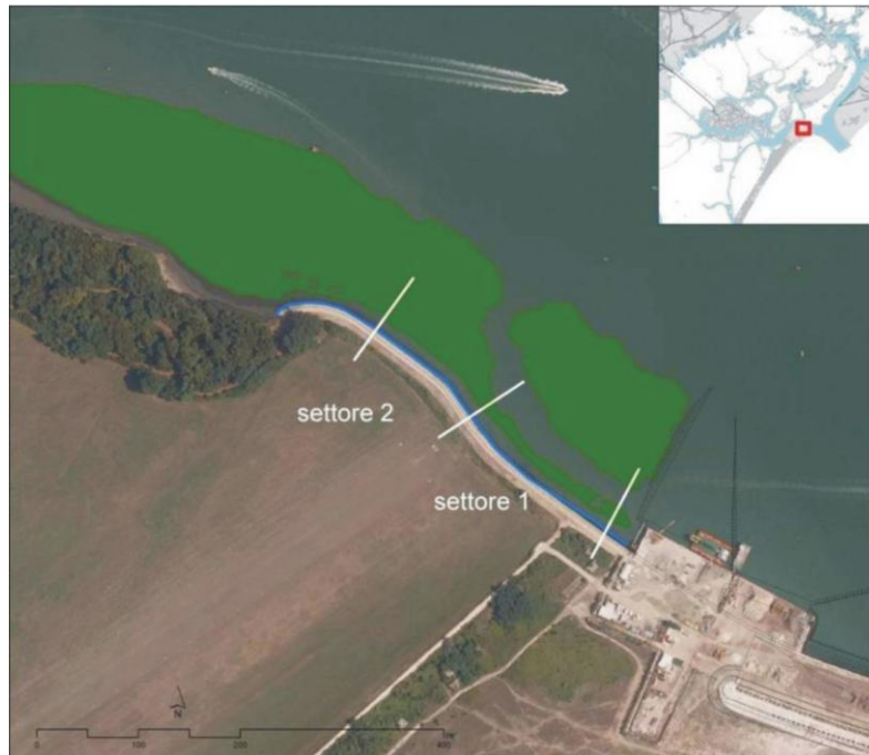
Figura 3.29 - Area oggetto della realizzazione delle opere con sovrapposte le fanerogame e i due settori nei quali, per motivi organizzativo-tecnici, i lavori di ripristino della riva sono svolti in due fasi temporali differenti.
