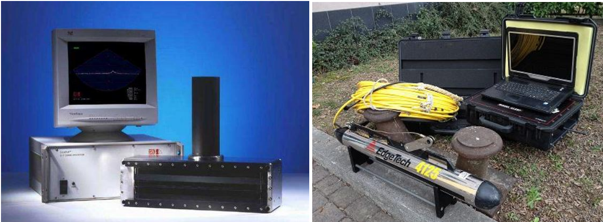
Figura 2.7. A sinistra è riportata una immagine del sistema Multibeam- Echosounder mentre, a destra, quella del Side Scan Sonar.
