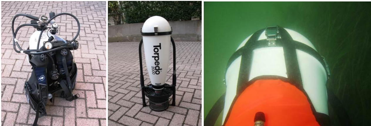
Figura 3.7. Attrezzatura subacquea impiegata nei rilievi del margine della prateria: a sinistra equipaggiamento standard FIPSAS composto da una bombola, jacket, due erogatori e un manometro; al centro e a destra veicolo elettrico per il trascinamento dei subacquei.
