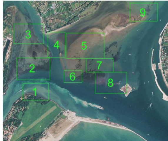
Figura 27 - Aree della bocca di Lido caratterizzate da evidenti cambiamenti di direzione delle velocità massime in prossimità della vegetazione.
