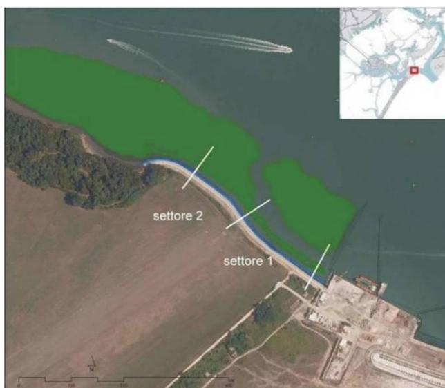
Figura 3.30 - Area oggetto della realizzazione delle opere con sovrapposte le fanerogame e i due settori nei quali, per motivi organizzativo-tecnici, i lavori di ripristino della riva sono svolti in due fasi temporali differenti.
