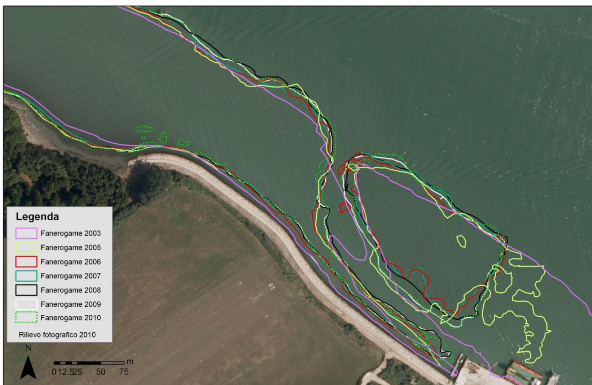
Figura 3.33 – Dettaglio dei margini tra gli anni 2003 e 2010 del tratto della prateria del Bacan ritenuto più esposto ai possibili impatti per la realizzazione delle opere. I limiti degli anni 2003-2007 fanno riferimento ad immagini fotografiche mentre quelli del 2008-2010 ad una combinazione di immagini fotografiche e di markers rilevati in immersione con attrezzatura ARA lungo il margine.
