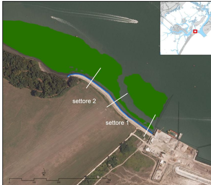
Figura 3.32 – Rilievo fotografico dell'area oggetto della realizzazione delle opere con sovrapposte le fanerogame e i due settori nei quali, per motivi organizzativo-tecnici, i lavori di ripristino della riva verranno svolti in due fasi temporali differenti.
