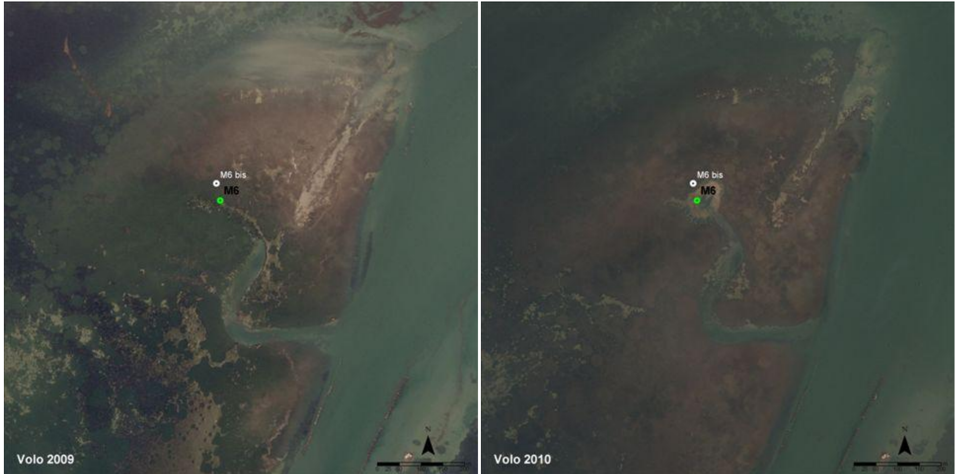
Malamocco, voli aerei estate 2009 ed estate 2010. Stazioni M6 e M6-bis: particolare dell'area di campionamento dove sono localizzate le stazioni M6 e M6-bis. È visibile (nel 2010) l'area dove è stato sversato sedimento limoso-argilloso, che è andato a ricoprire completamente la prateria presente.
