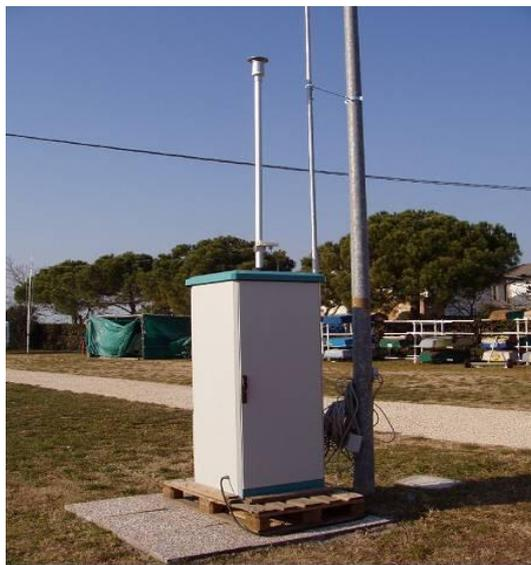
Fig. 1.1 - Campionatore automatico sequenziale di PM<sub>10</sub> (Air Genius, Unitec, Ferrara).
