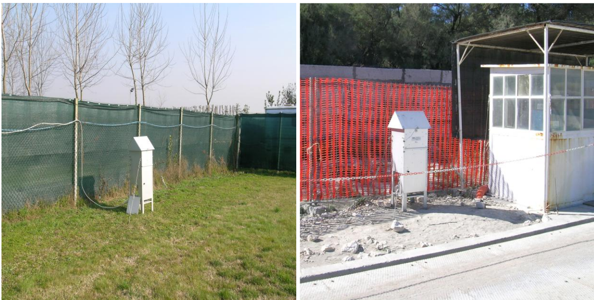
Fig. 3.1 – Campionatore di IPA presso la bocca di Punta Sabbioni (sinistra) e a Malamocco (destra)
