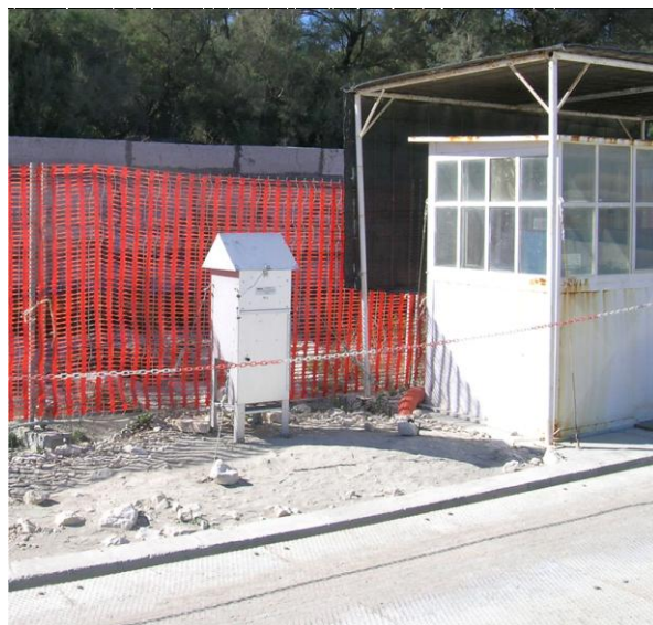
Fig. 3.1 – Campionatore di IPA presso la bocca di Malamocco
