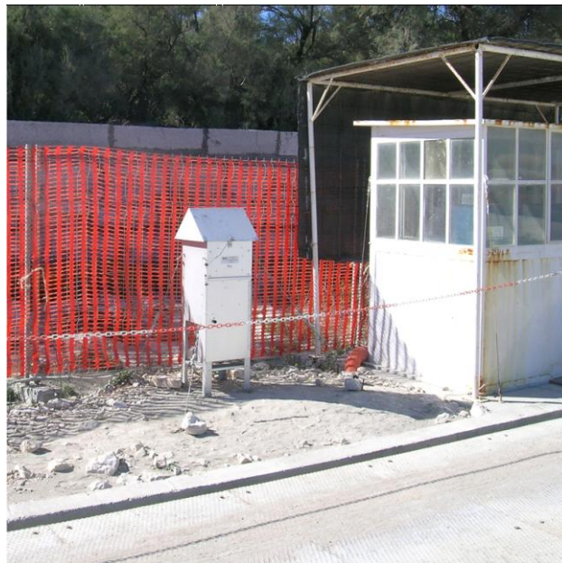
Fig. 2.3 - Campionatore di IPA presso la bocca di Malamocco (stazione IPA2, Fig. 2.1)
