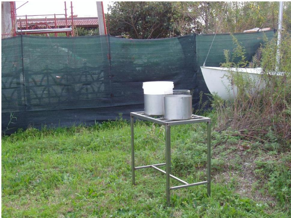
Fig. 4 – Deposimetro situato all'interno della Vela in prossimità del Lungomare (DEP2)
