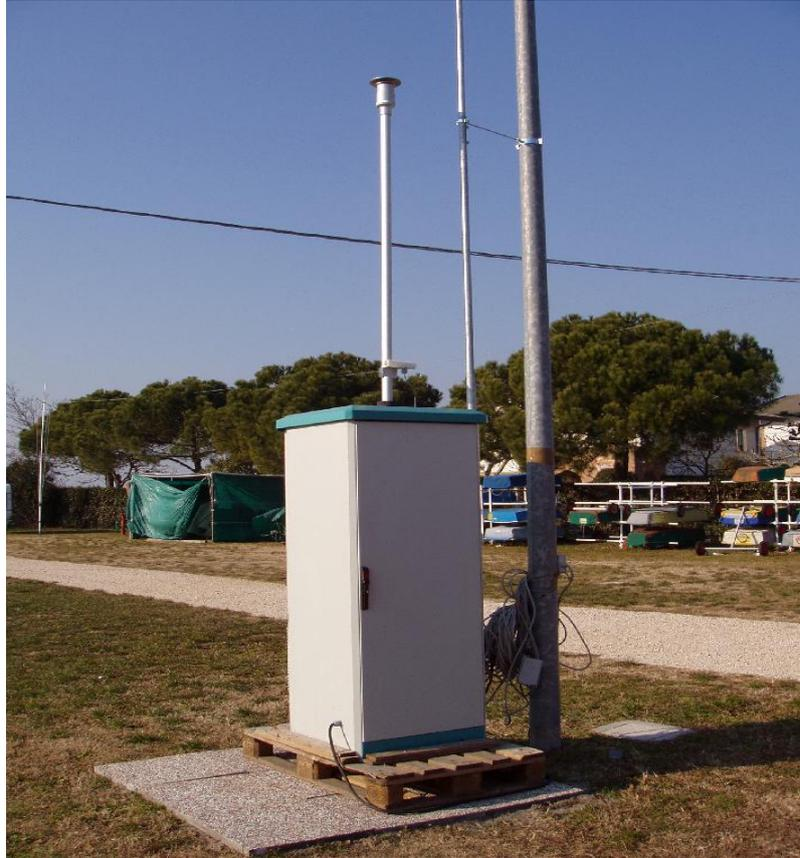
Fig. 8 – Campionatore automatico sequenziale di PM10 (Air Genius, Unitec, Ferrara)
