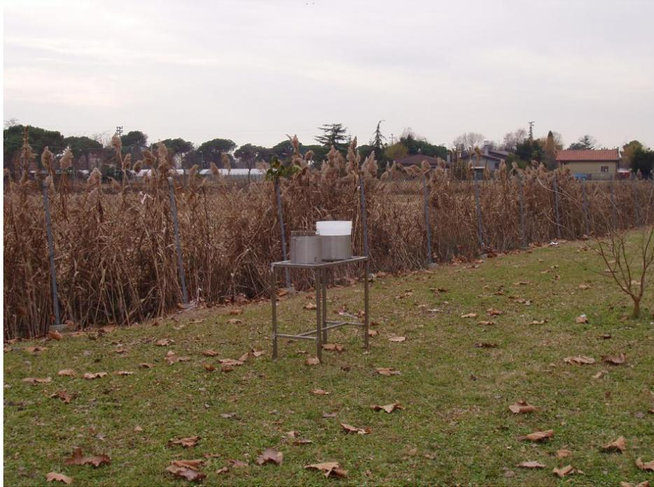
Fig. 6 – Deposimetro situato presso la Scuola Elementare S. Pertini di Punta Sabbioni (DEP4)
