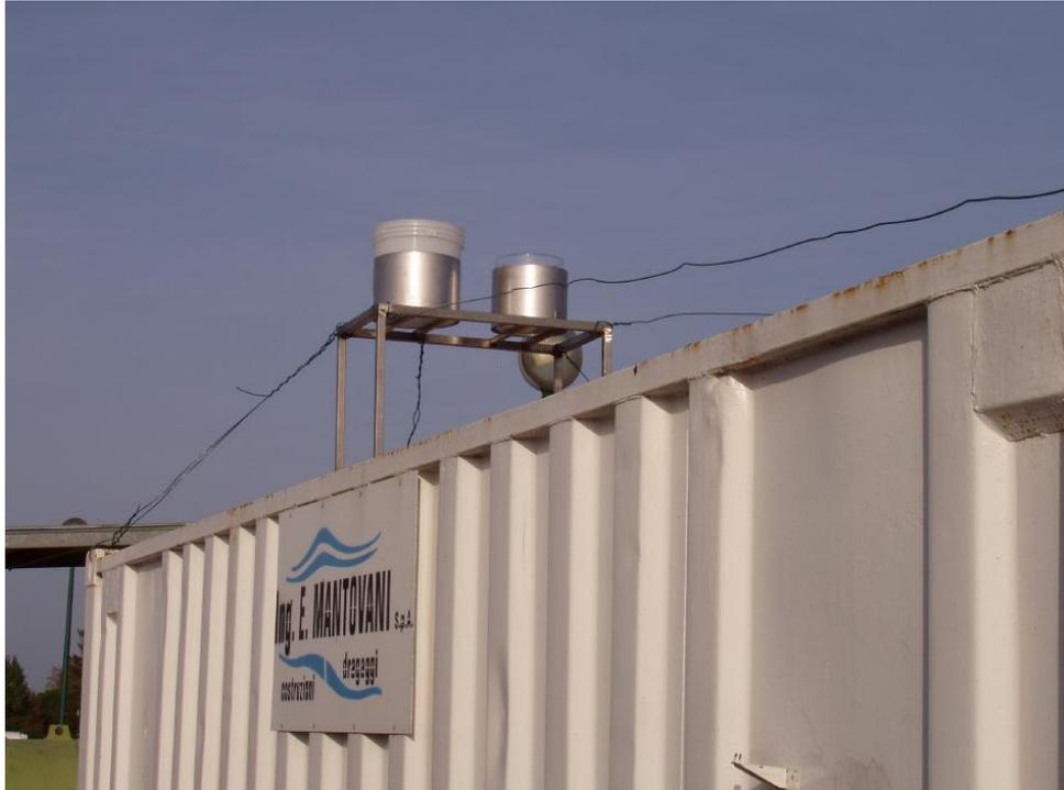
Fig. 3 – Deposimetro situato nell'area del cantiere (DEP1)
