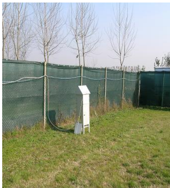
Fig. 2.5 - Campionatore di IPA presso la bocca di Punta Sabbioni (stazione IPA3, Fig. 2.1)
