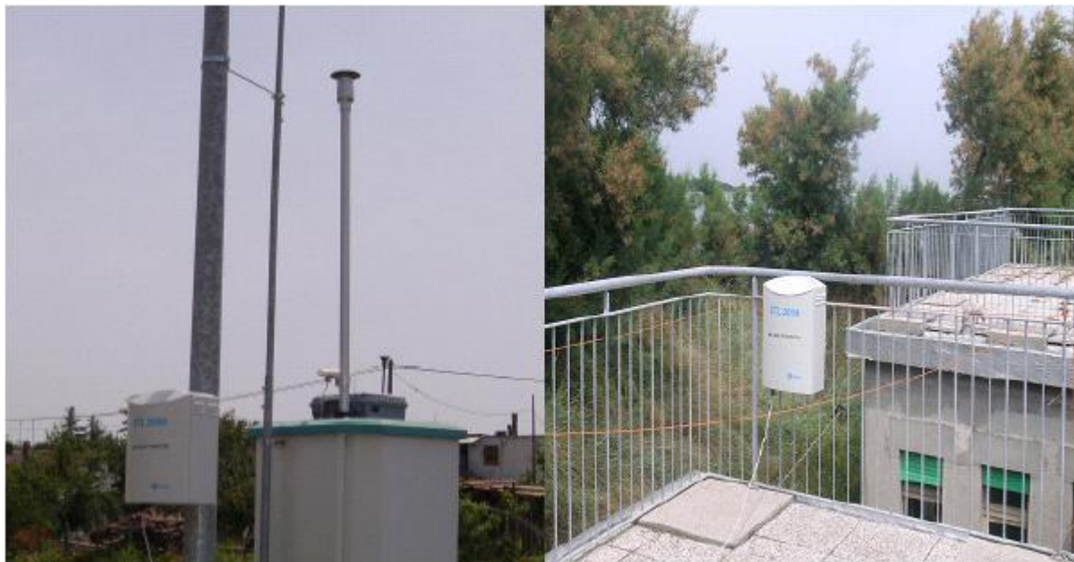
Fig. 3.2 - Stazione misura dei gas ETL2000 a Punta Sabbioni (sinistra) e a Malamocco (destra).
