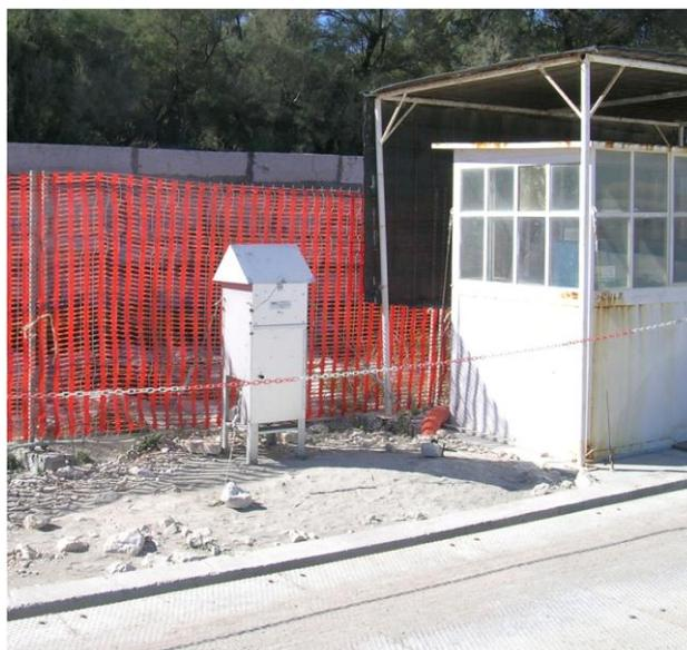
Fig. 3.2 - Campionatore di IPA presso la bocca di Malamocco
