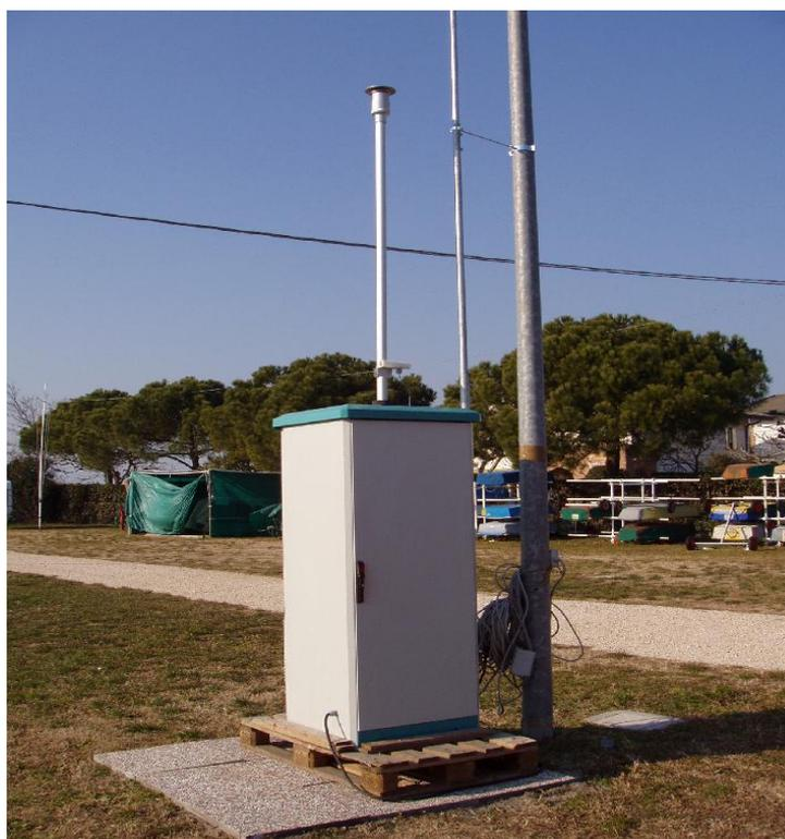
Fig. 1.8 – Campionatore automatico sequenziale di PM10 (Air Genius, Unitec, Ferrara)
