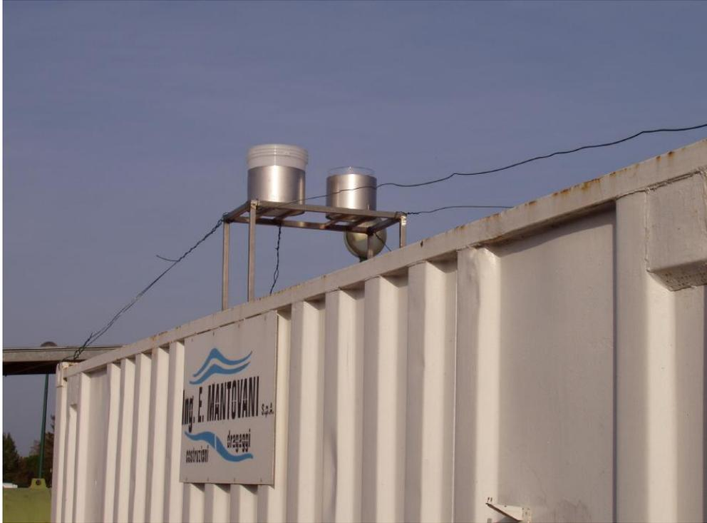
Fig. 1.3 - Deposimetro situato nell'area del cantiere (DEP1)
