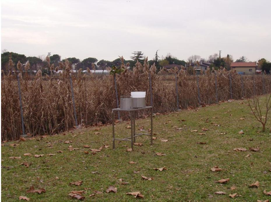
Fig. 1.6 – Deposimetro situato presso la Scuola Elementare S. Pertini di Punta Sabbioni (DEP4)
