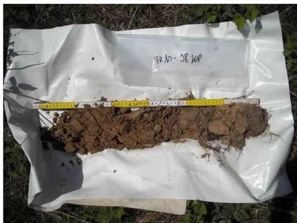
Fig.8.2.: Carota per il campionamento del *top-soil* e *sub-soil* su transetto PS10
