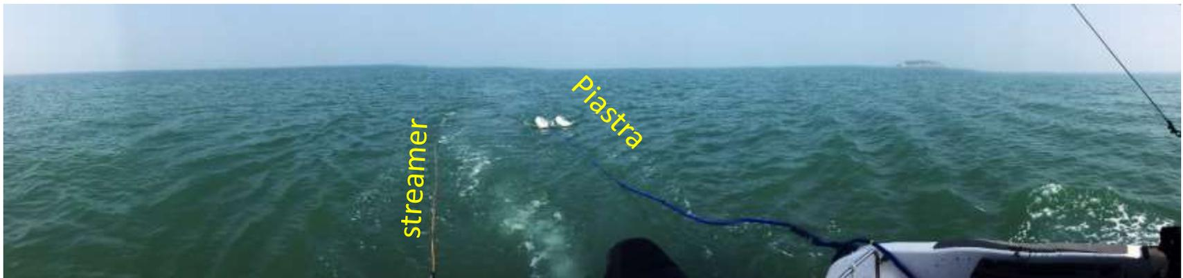
Sistema di acquisizione sismica a riflessione monocanale ad altissima risoluzione (BOOMER) ottimizzato per bassissimi fondali (80-100 cm) composto da una sorgente elettrodinamica e uno streamer di 3 m con 8 idrofoni. La sorgente emette onde a larga banda (400-9000 Hz). Consente una risoluzione di 20 cm e una penetrazione di 20-30 m.
