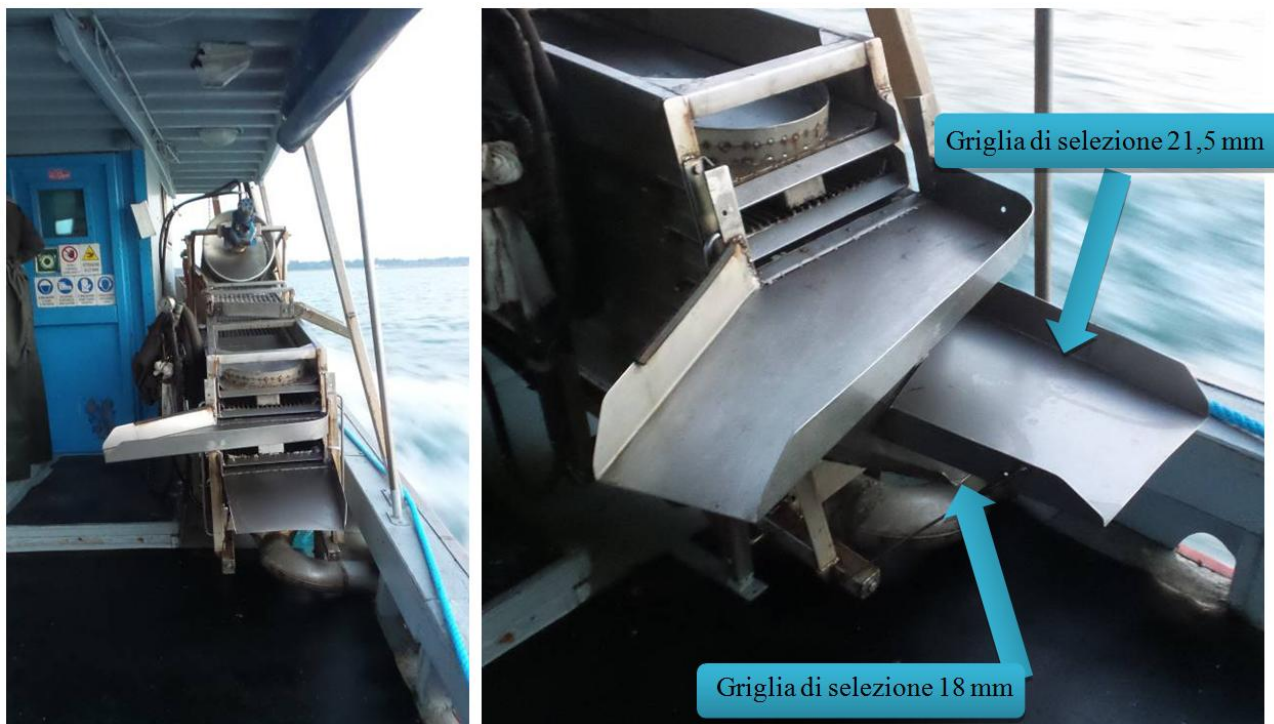
Foto 3: Vibrovaglio del motopesca Antartide settato per il monitoraggio.
