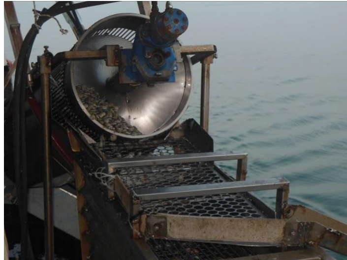
Foto 7: Passaggio del prodotto alla vite rotante e successivamente al vibrovaglio.
