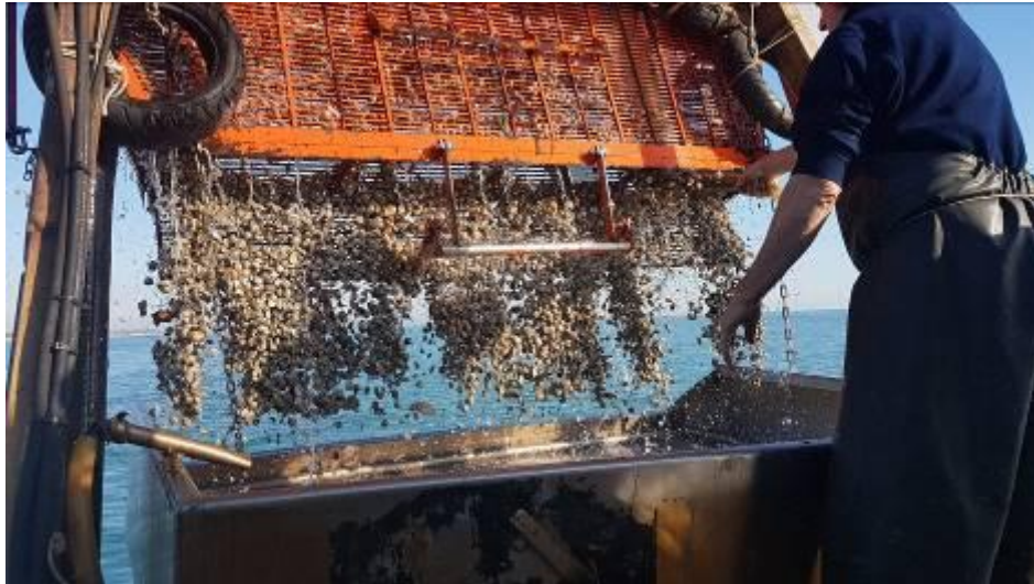
Foto 4. Apertura del ferro e svuotamento del prodotto nella vasca di prua.
