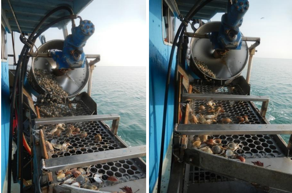
Foto 9. Passaggio del prodotto alla vite rotante e successivamente al vibrovaglio.
