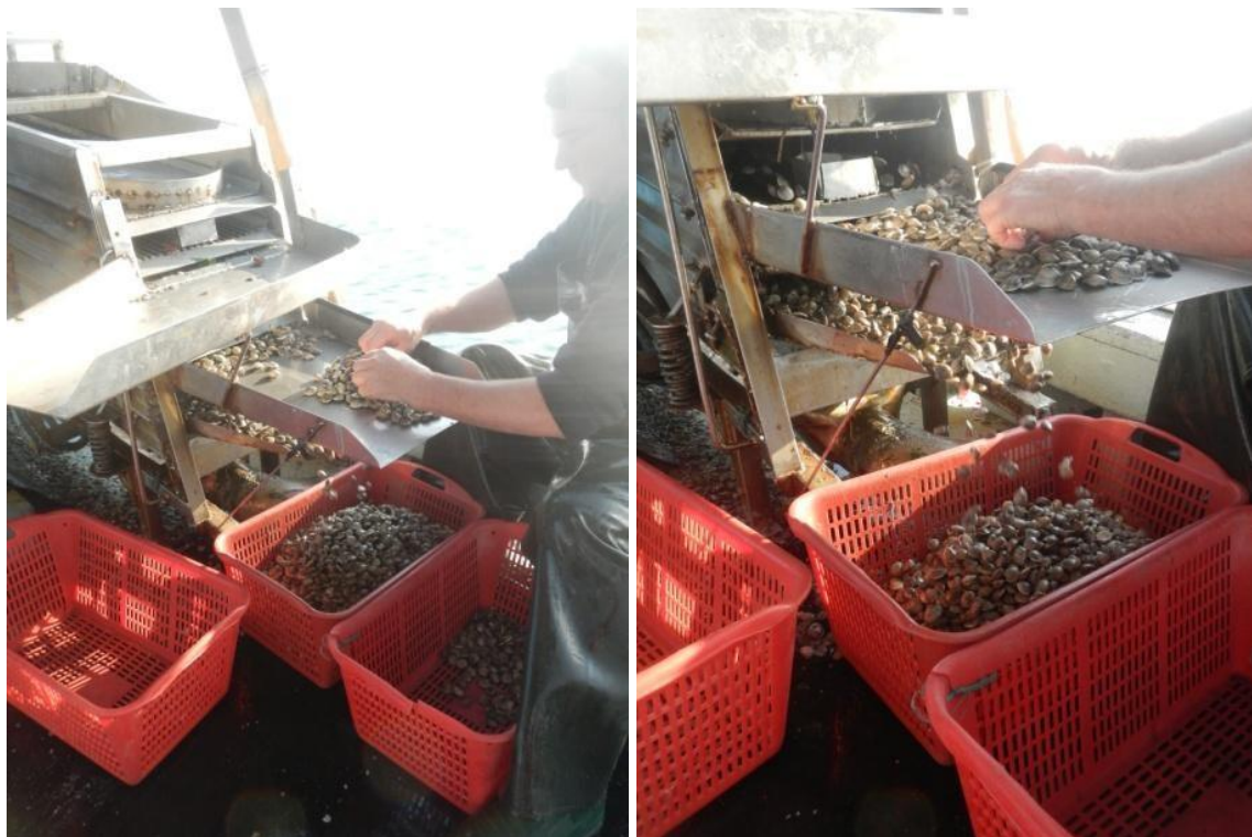
Foto 10. Selezione delle vongole per taglia alle diverse griglie del vibrovaglio.
