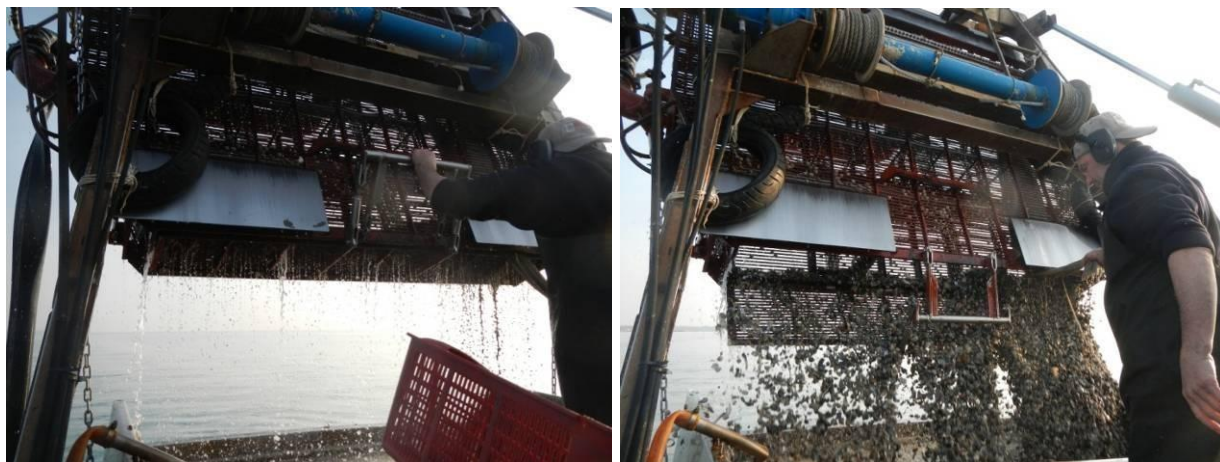
Foto 6. Apertura del ferro e svuotamento del prodotto nella vasca di prua.
