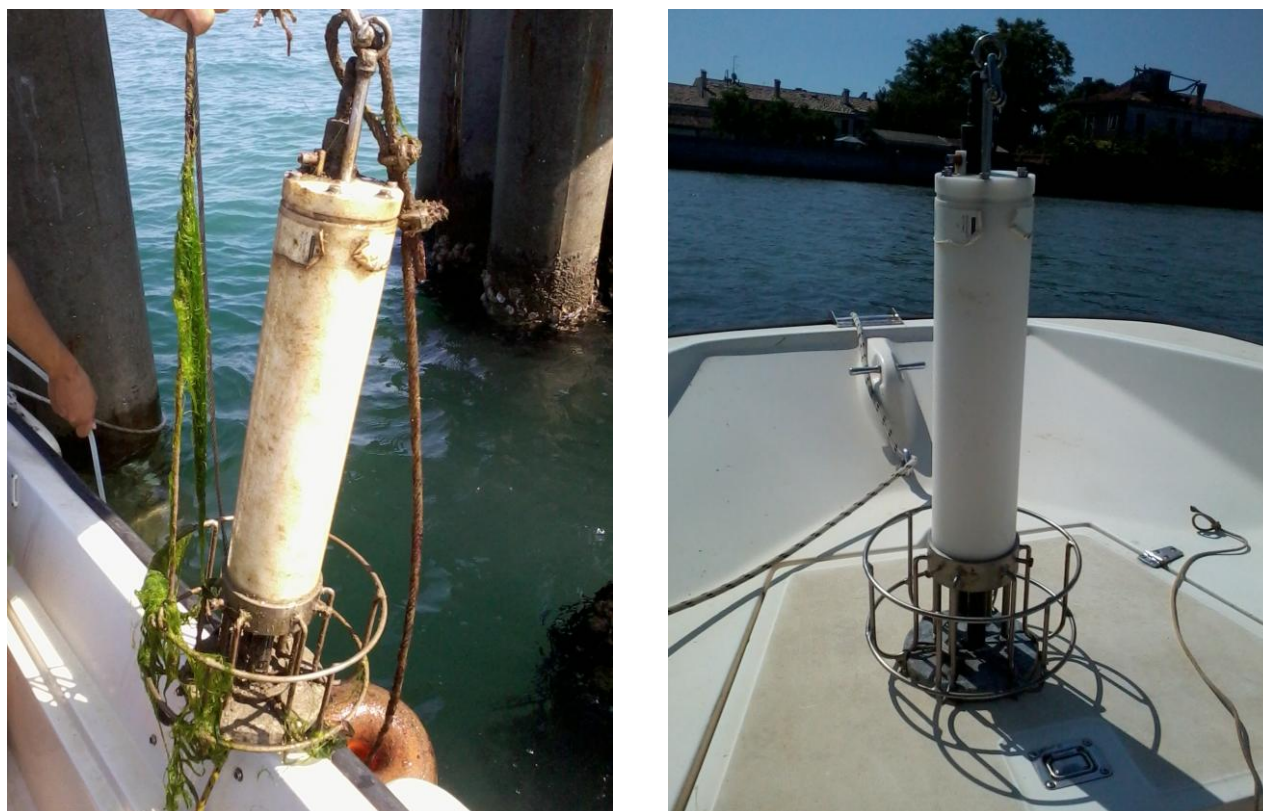
Figura 2.7. Sonda della stazione LTP prima (a sinistra) e dopo la pulizia (a destra) (18/07/2013).
