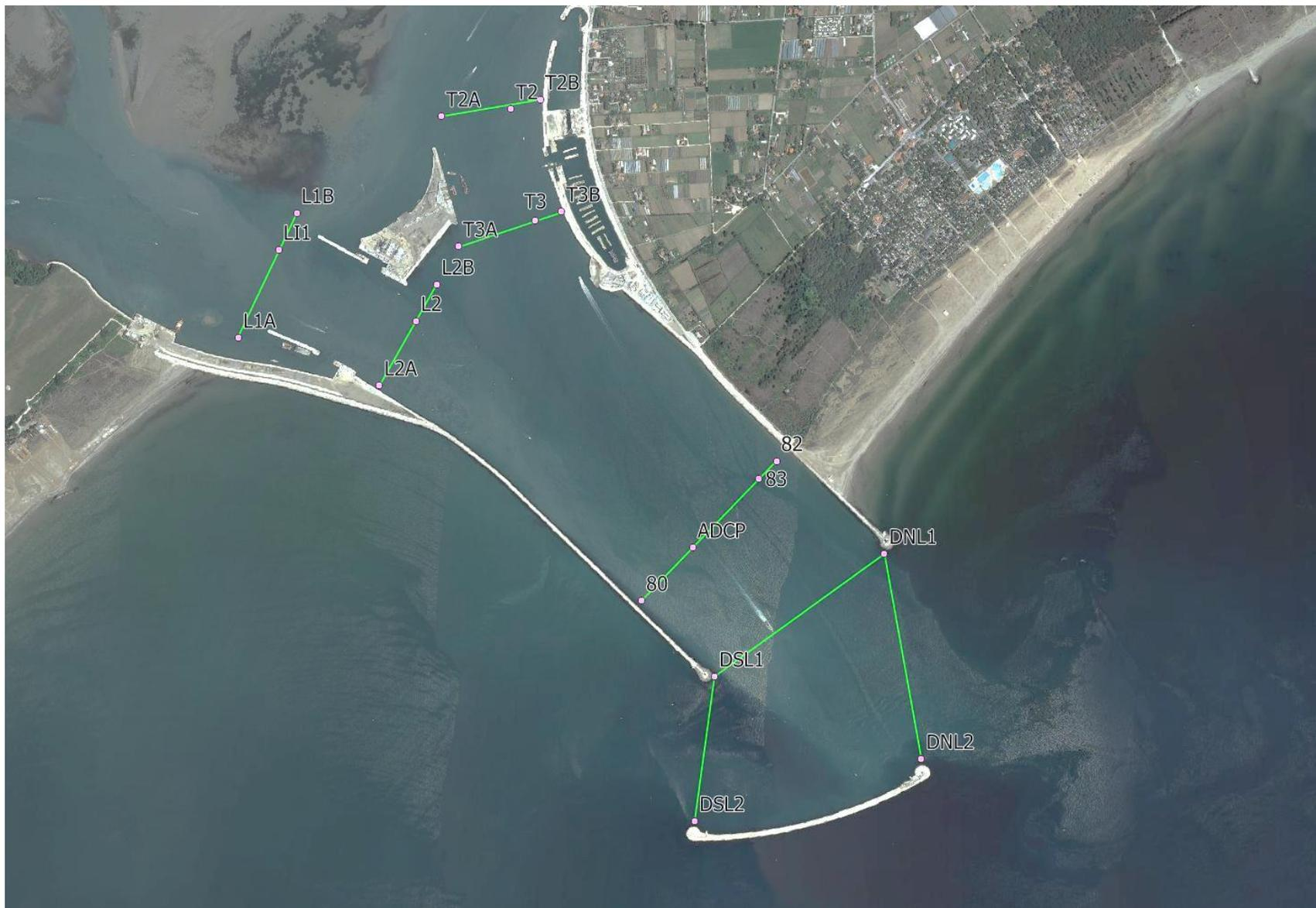
Figura 2.1. Posizione dei punti notevoli e dei transesti (sezioni caratteristiche) della campagna di monitoraggio L1B10 effettuata alla bocca di porto di Lido.
