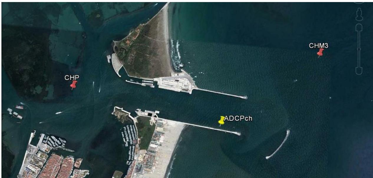
Figura 6.2. Bocca di porto di Chioggia: ADCP fisso (in giallo) e stazioni torbidimetriche (in rosso).
