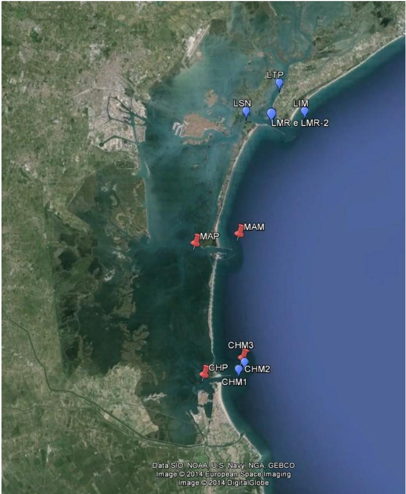
Figura 5.1. La rete delle stazioni fisse per la misura della torbidità in continuo. In rosso le stazioni attive nel 2014-2015. In blu le stazioni attive nel corso dei precedenti anni di monitoraggio.
