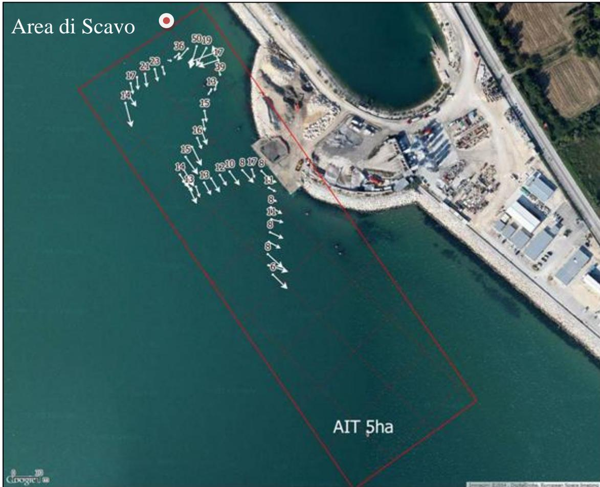
Figura 4.4 Andamento della concentrazione media sulla verticale (valori puntuali) del particolato solido sospeso durante l'esecuzione del percorso a "zig-zag" effettuato per monitorare le attività di scavo (Transetto L1B10\_035.PD0) alla bocca di Lido il 6 agosto 2014. Il cerchio bianco e rosso indica la posizione della draga.
