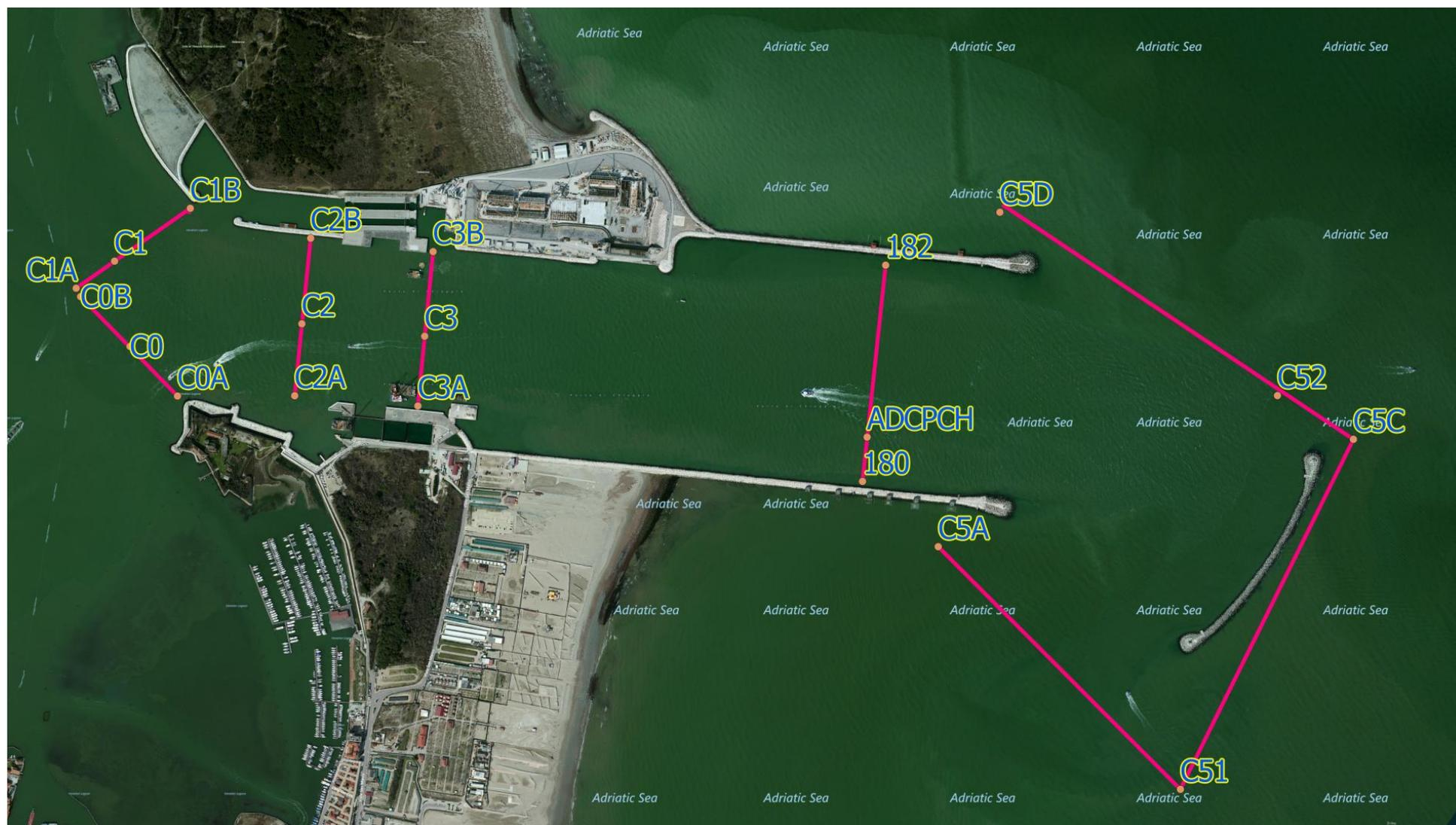
Figura 2.3. Posizione dei punti notevoli e dei transetti (sezioni caratteristiche) delle campagne di monitoraggio C1B10 e C2B10 (febbraio e marzo 2015) effettuate alla bocca di porto di Chioggia
