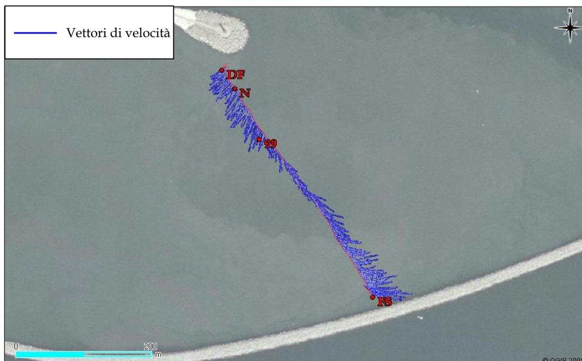
Figura 2.20. Campo di velocità del transetto Malamocco\_024r.000 delle ore 08.18 del giorno 28 Agosto sovrapposto alla ortofoto (volo 2007, Magistrato alle Acqua di Venezia).
