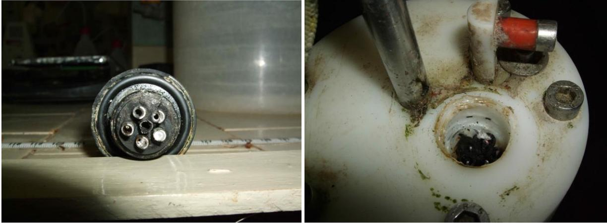
Figura 5.6 Esempio di danno alla testata della sonda nella stazione CHP: le saldature di collegamento del cavo di trasmissione dati tra la sonda ed il PC si sono irrimediabilmente danneggiati (fusione del conduttore probabilmente a seguito di corto; 20 Novembre 2008).
