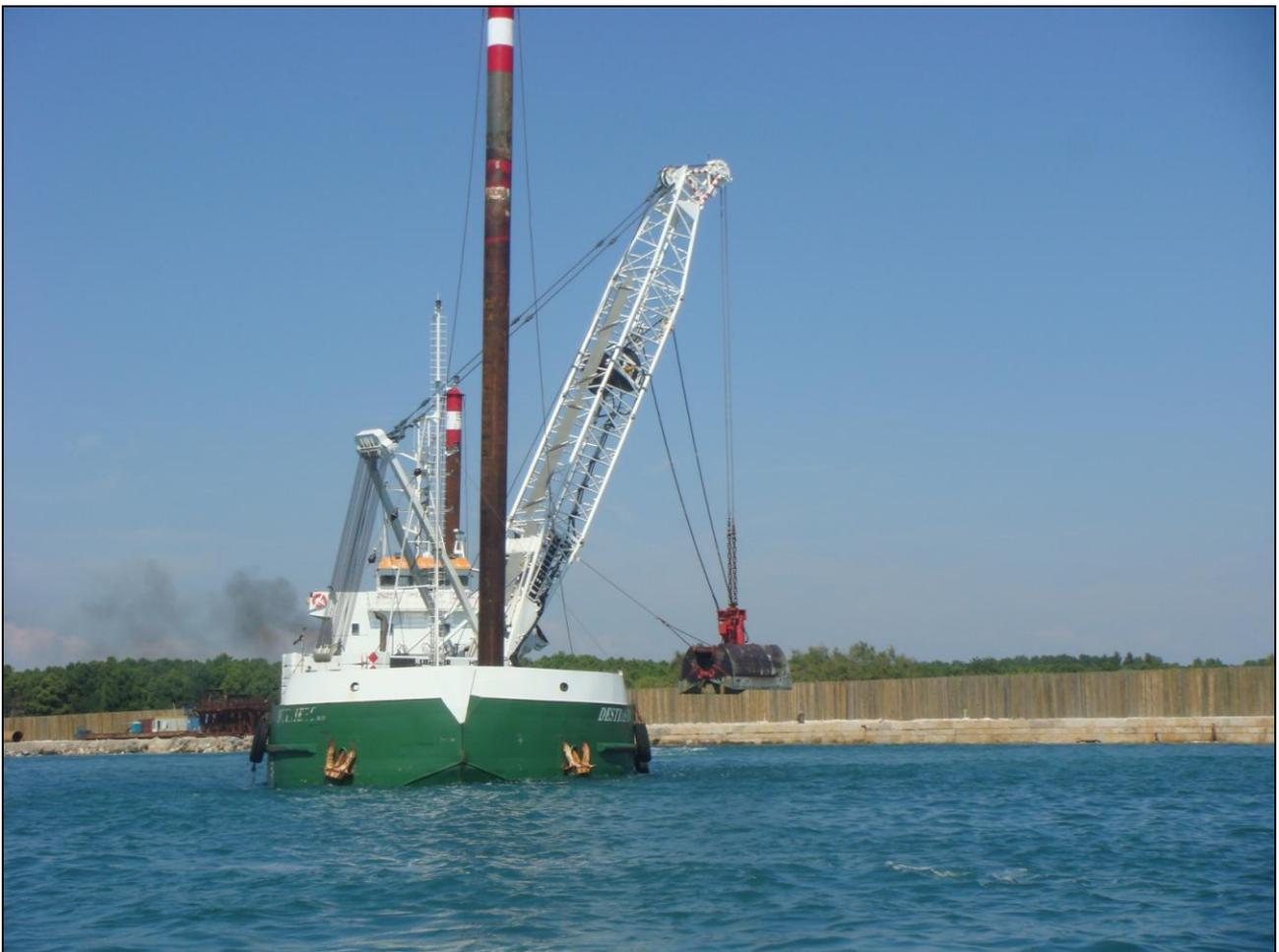
Figura 2.18. Draga "Destriero Primo" in azione presso il canale principale della bocca di porto di Malamocco
