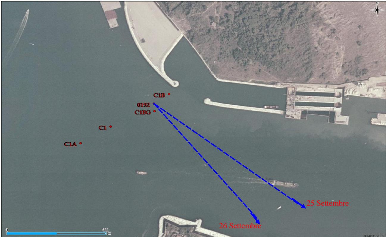
Figura 4.12. Vettori di spostamento ricavati dai dati del *bottom tracking* misurati dalla strumentazione ADCP sistemata al fondo (Punto 0192).
