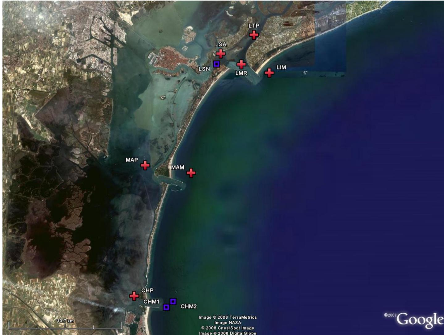
Figura 5.1. La rete delle stazioni fisse per la misura della torbidità in continuo. In rosso le stazioni attive nel 2008-2009.
