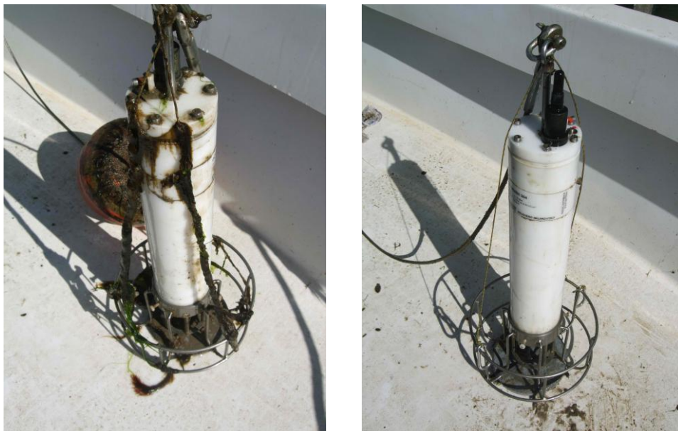
Figura 1.10. Operazioni di pulizia di una sonda multiparametrica: sonda prima della pulizia (a sin.) e dopo (a dx.) (6 marzo 2009).
