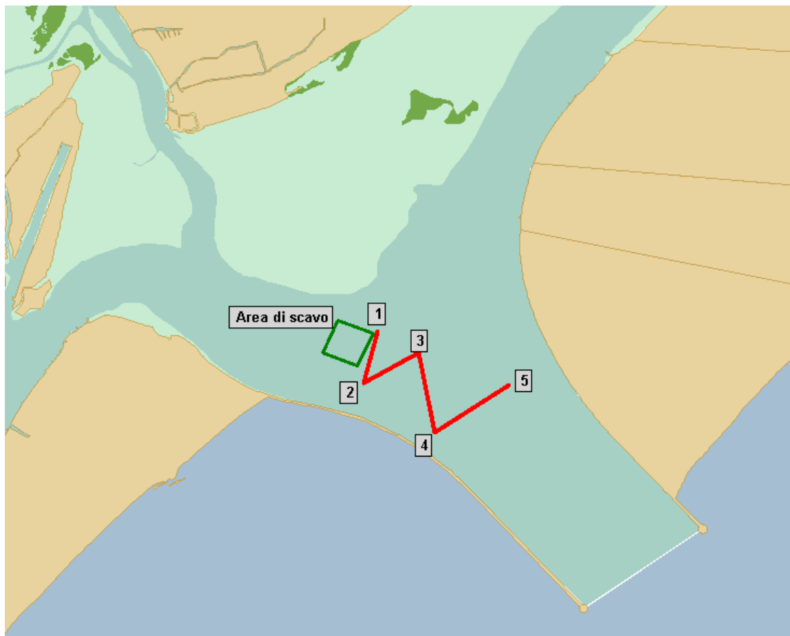
Figura 2.27 Mappa con la traccia del primo percorso a zig-zag (in rosso) a valle dell'area di scavo (quadrato verde).
