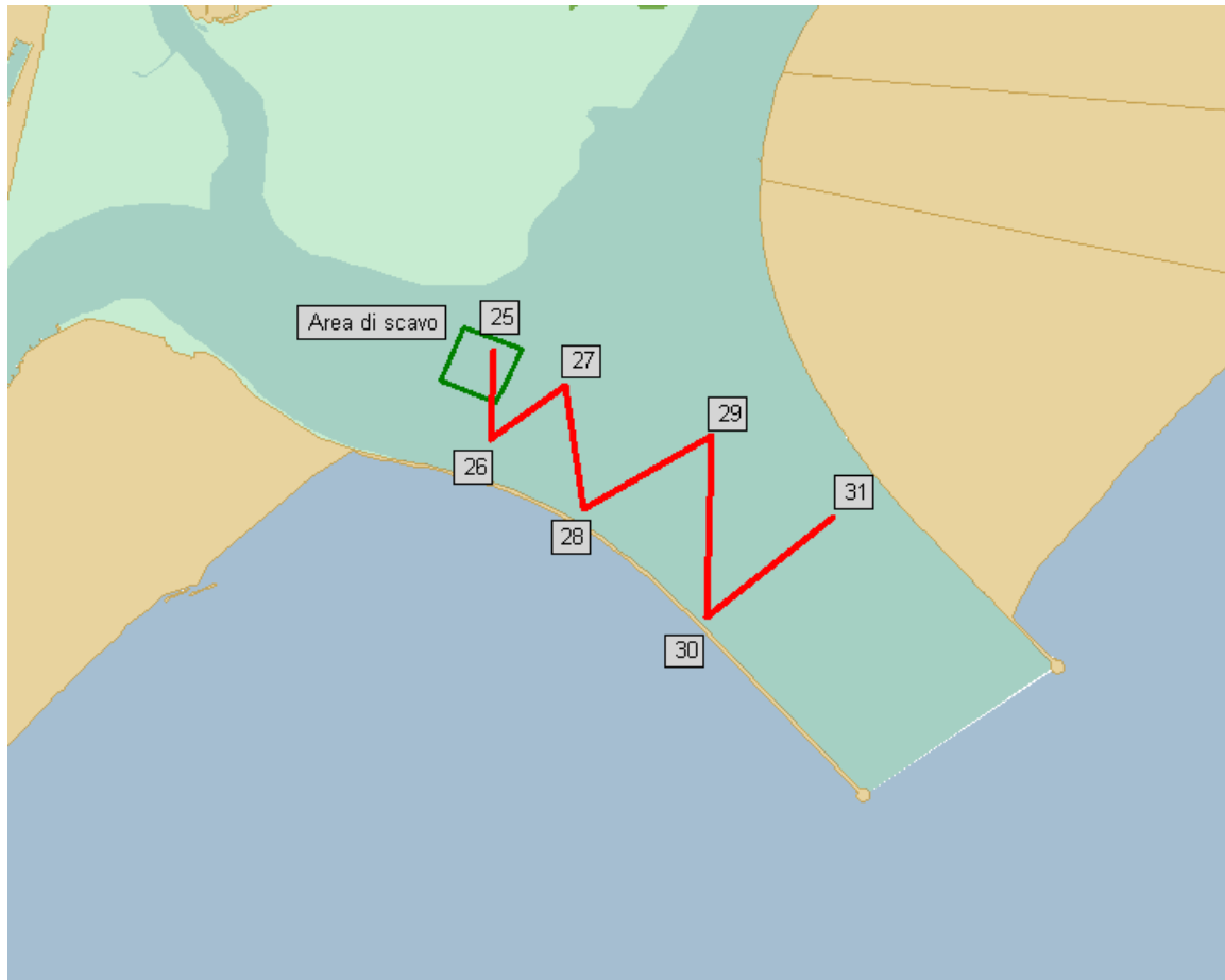
Figura 2.50 Mappa con la traccia del primo percorso a zig-zag (in rosso) a valle dell'area di scavo (quadrato verde).
