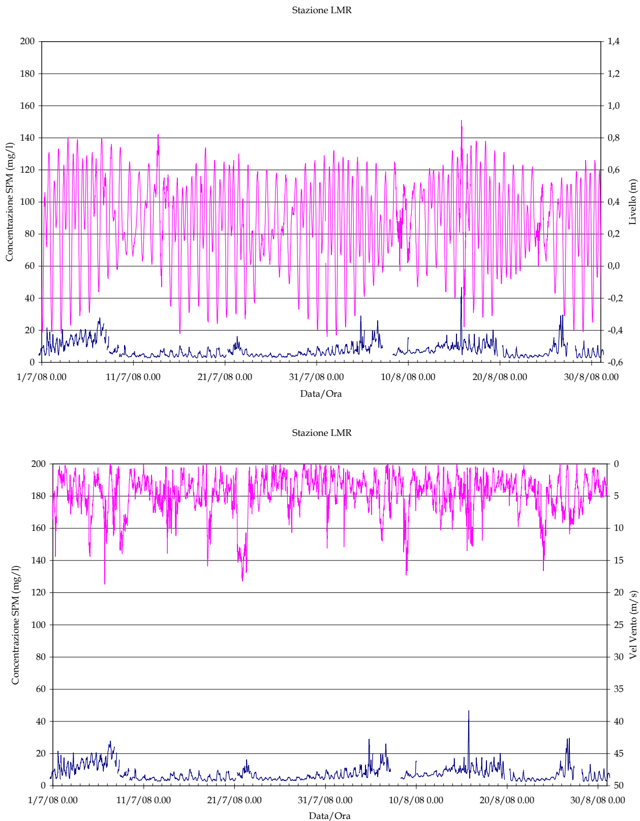
Figura 2.5 (b). Serie temporale della concentrazione di SPM e del livello idrico (in alto) e della velocità del vento (in basso) alla stazione LMR nel periodo Luglio-Agosto 2008.
