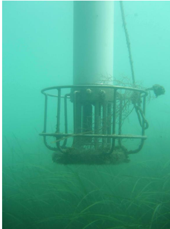
Figura 1.6. Immagine subacquea di una sonda multiparametrica, al di sopra di una prateria a fanerogame (stazione MAP).
