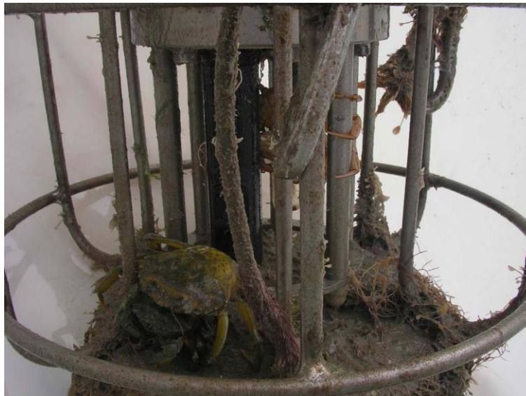
Figura 1.7. Particolare della testa di una sonda 304 CTD-T dopo 15 giorni di immersione. (Stazione MAP, 4 agosto 2008).
