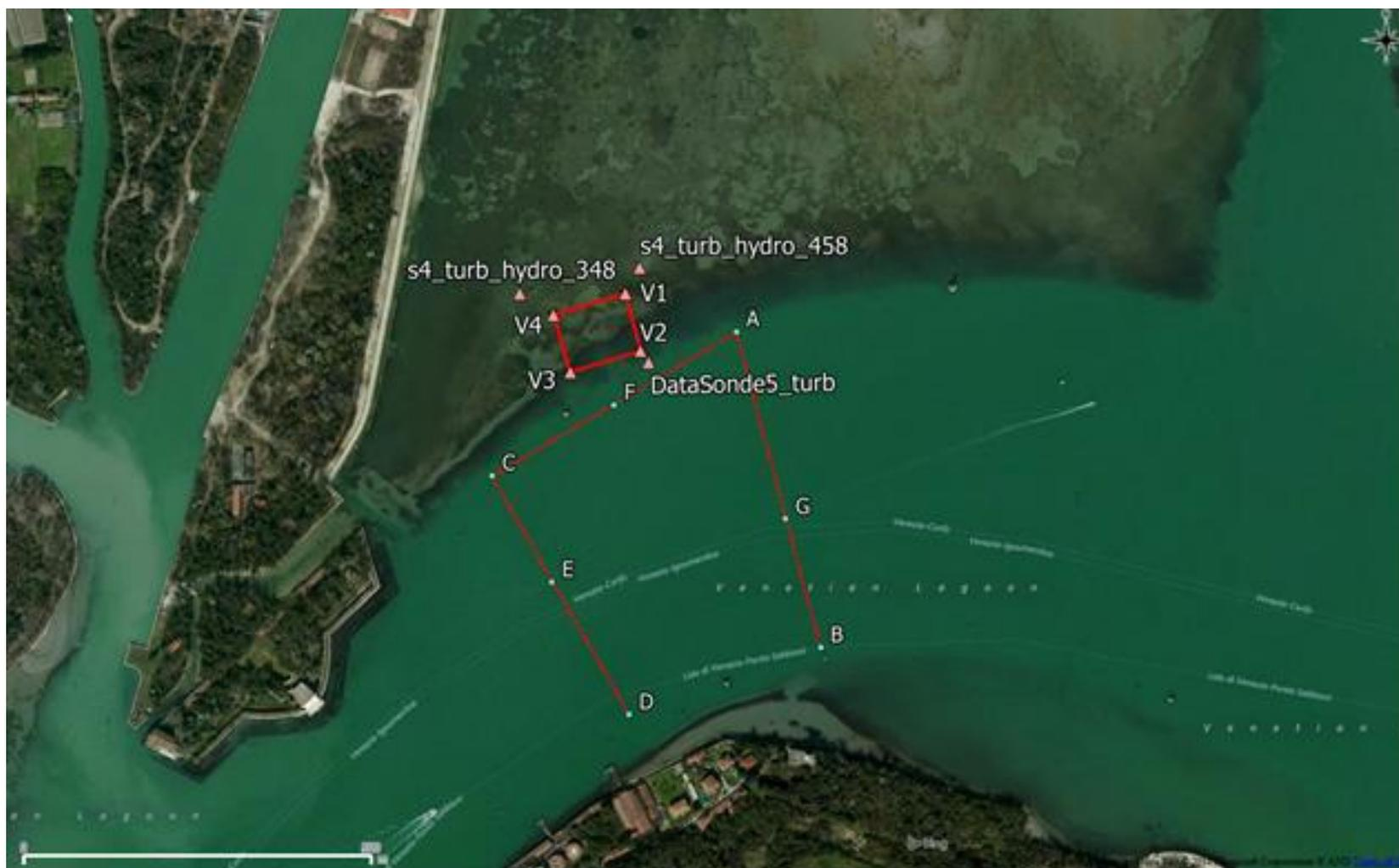
Figura2.4. Posizione dei punti notevoli e dei transetti (sezioni caratteristiche) delle campagne di monitoraggio L2B8 effettuata in bocca di porto di Lido.
