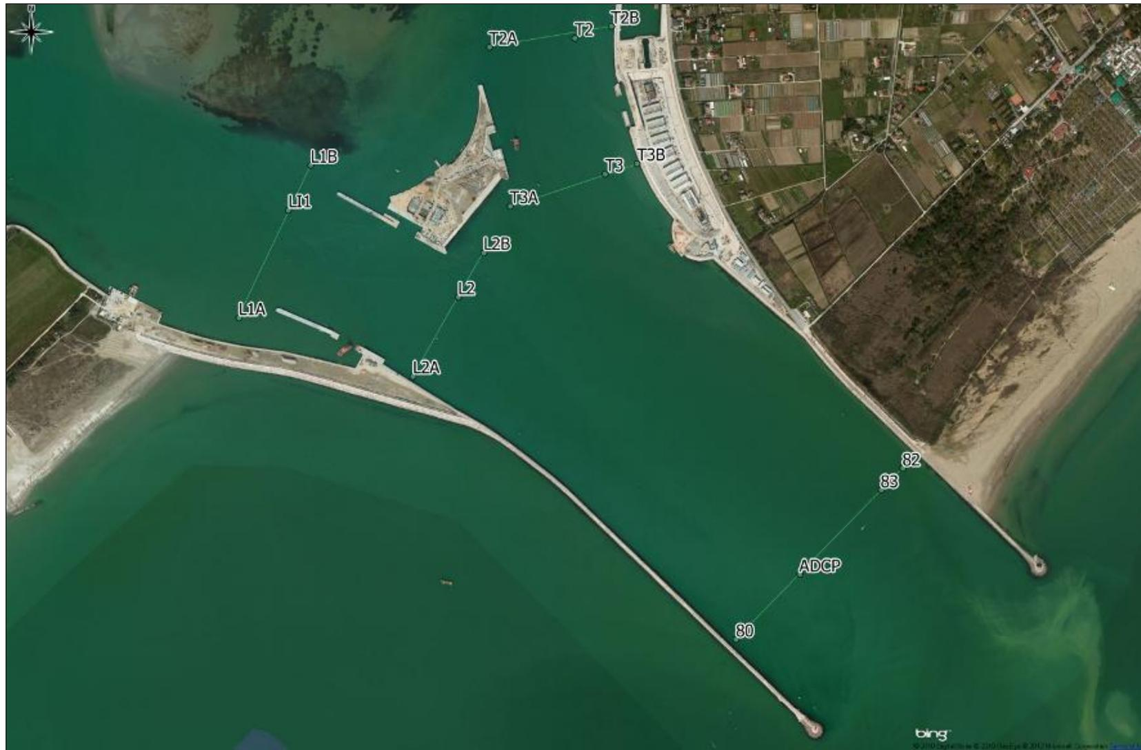
Figura2.3. Posizione dei punti notevoli e dei transetti (sezioni caratteristiche) delle campagne di monitoraggio L1B8 effettuata in bocca di porto di Lido.
