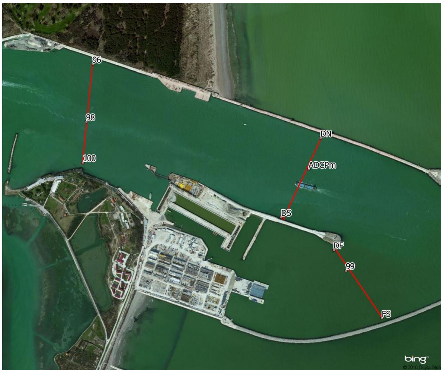
Figura 2.2. Posizione dei punti notevoli e dei transetti (sezioni caratteristiche) delle campagne di monitoraggio M2B8 effettuata in bocca di porto di Malamocco.
