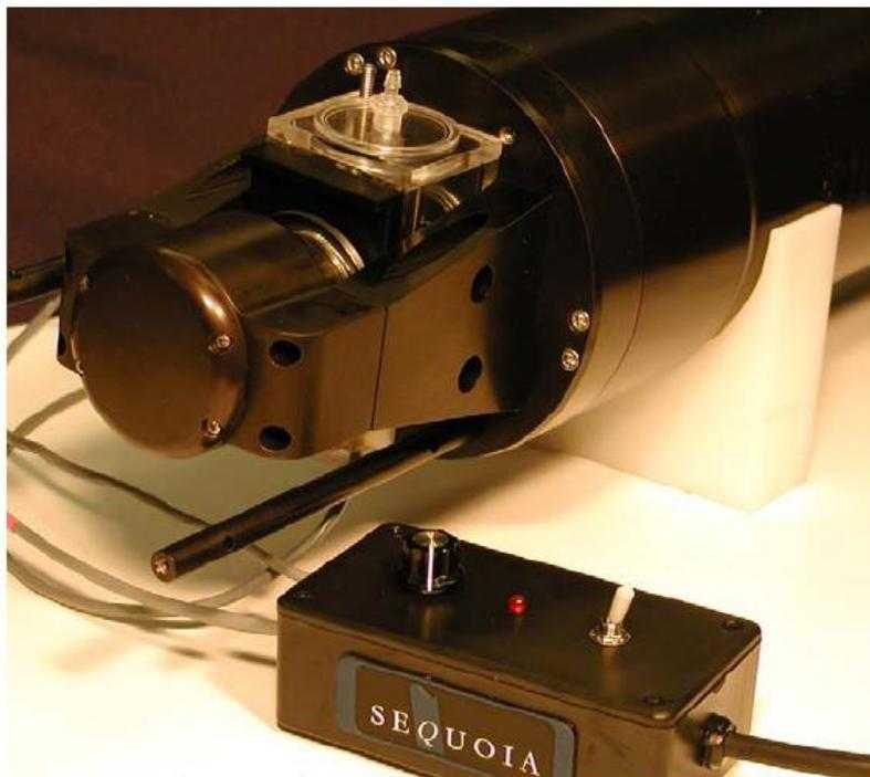
Figura 6. LISST attrezzato per le analisi di laboratorio. Nella foto si vede la cella in cui viene inserito il campione e l'agitatore magnetico (in primo piano) ad essa associato.
