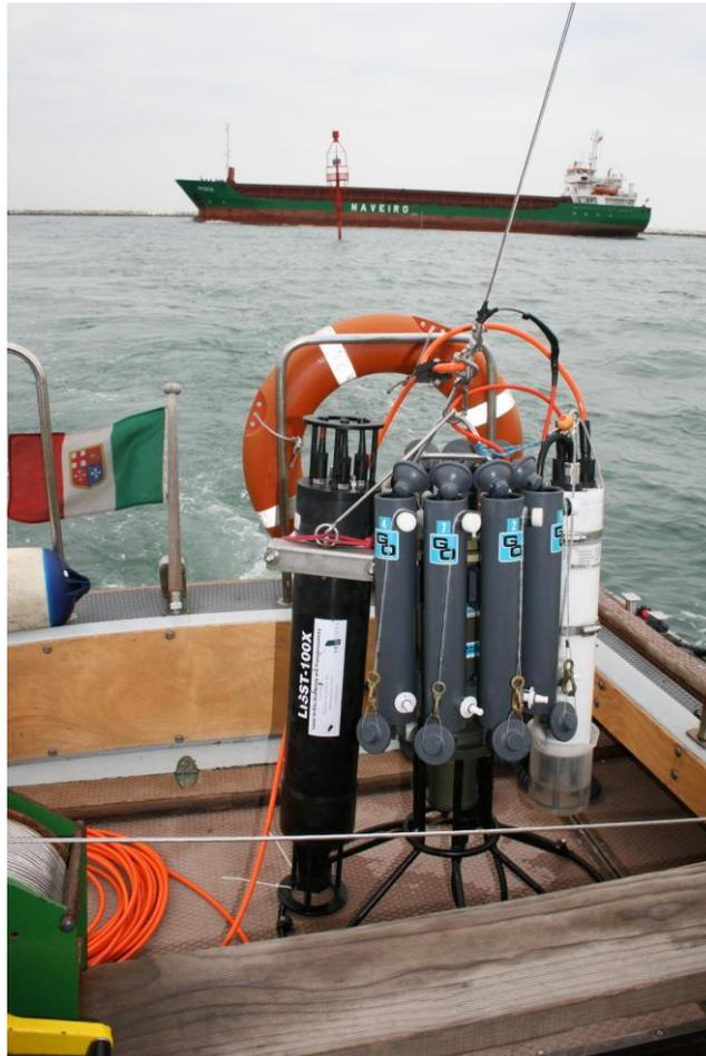
Figura 7. Strumentazione utilizzata durante le campagne del LISST-100X. Il LISST è montato insieme alla sonda multiparametrica (a destra nella foto) ed al campionatore a Rosette. Nella foto è anche visibile il verricello grazie al quale viene operata la strumentazione, ed il cavo rosso per la trasmissione dei dati.
