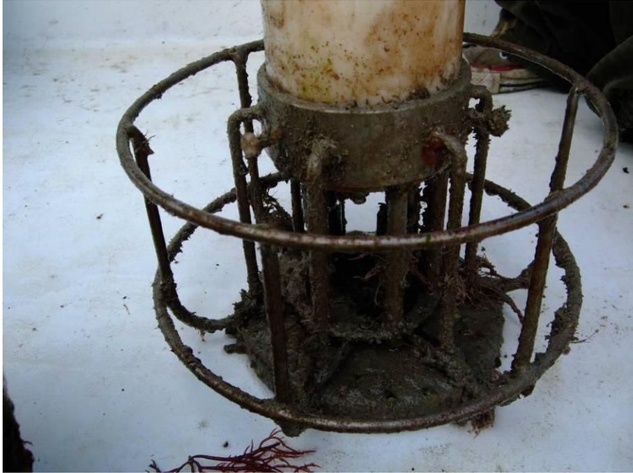
Figura 2.6. Sonda LTP prima delle operazioni di pulizia (07/09/11)
