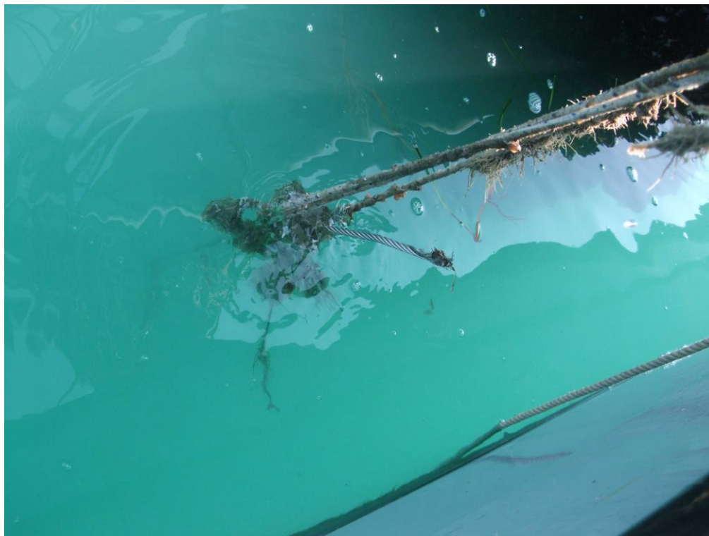
Figura 6.7. Rottura del cavo della sonda LIM
