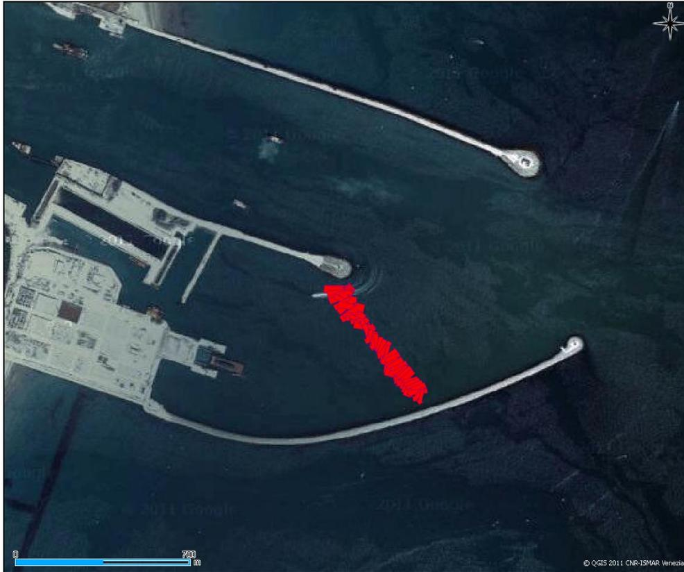
Figura 2.21. Proiezione della direzione di corrente media lungo il transetto sulla sezione DF - FS. La disposizione dei vettori evidenzia la forma del vortice che si instaura nel bacino di evoluzione della conca di navigazione durante le fasi di flusso e riflusso. Condizioni di marea calante.
