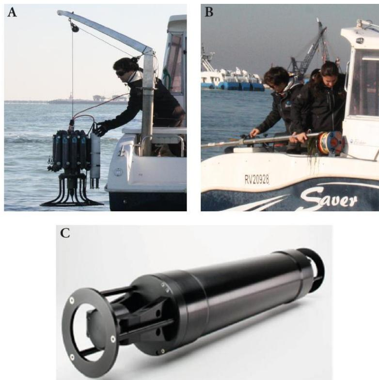
Fig. 3.1. Strumentazione oceanografica utilizzata: A) sistema Rosette-CTD, B) ADCP e C) LISST-granulometro laser 100X.
