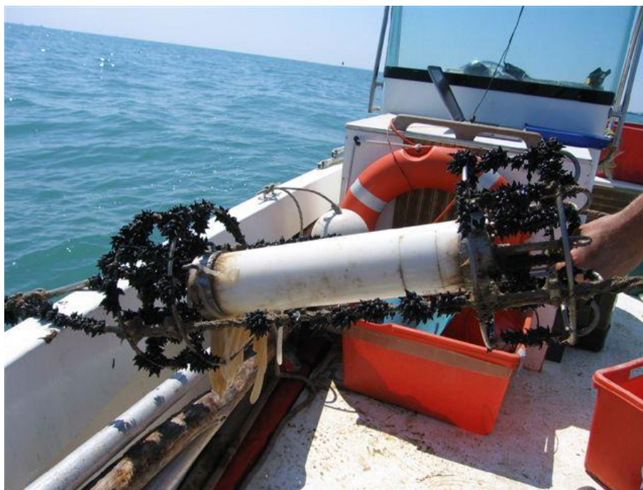
Figura 6.9. Particolare della testa di una sonda 304 CTD-T dopo 15 giorni di immersione. (Stazione LIM, 26 Aprile 2007)
