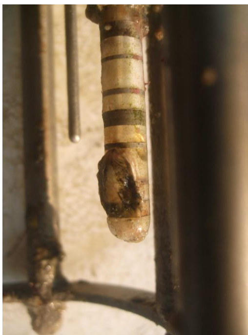
Figura 1.7. Immagine di una sonda multiparametrica a cui è attaccata una piccola ostrica.
