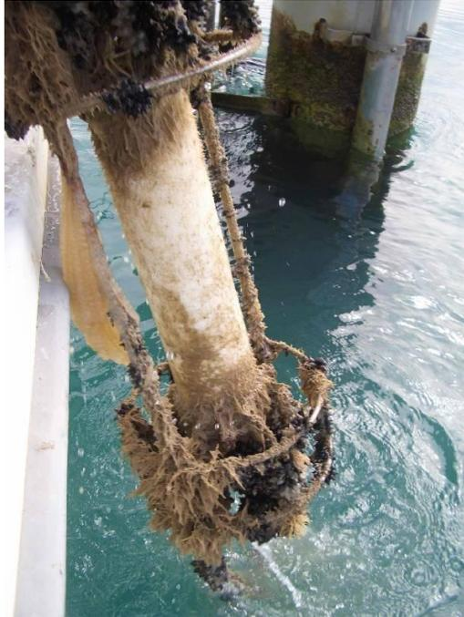
Figura 1.10. Immagine di una sonda multiparametrica a cui sono attaccate uova di calamaro.
