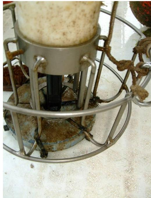
Figura 1.7 Stato della sonda dopo le operazioni di pulizia.
