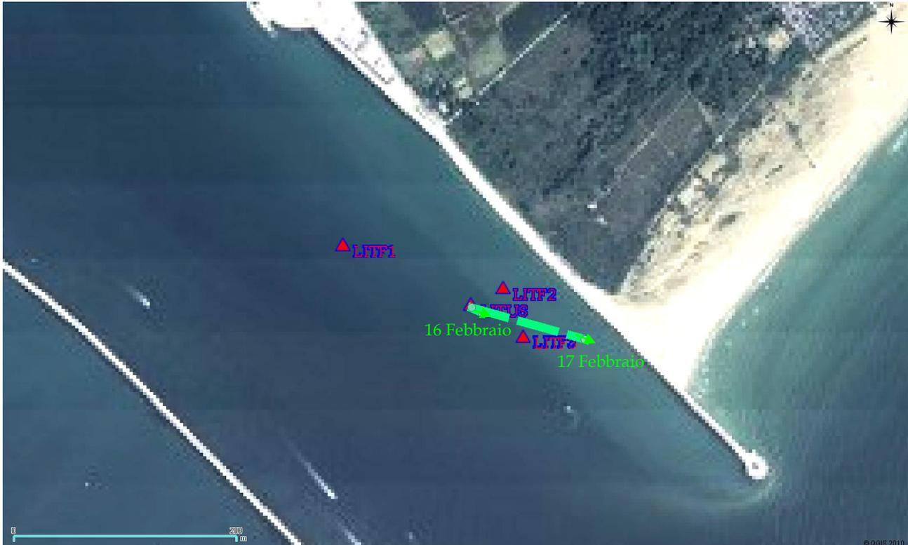
Figura 4.10. Vettori di spostamento ricavati dai dati del *bottom tracking* misurati dalla strumentazione ADCP sistemata al fondo (Punto LITUS).
