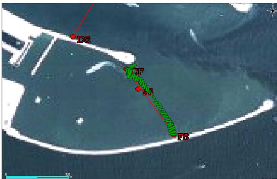
Figura 2.16. Vettori della velocità di corrente del vortice presso il bacino di evoluzione della conca di navigazione. Condizioni di marea crescente. Transetto Ma07\_000r.000 del 21 luglio 2009 ore 08.05.
