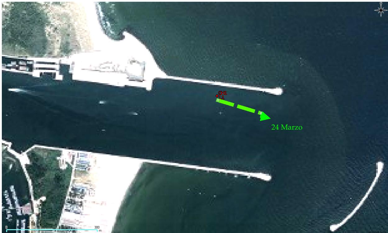
Figura 4.23. Vettori di spostamento ricavati dai dati del *bottom tracking* misurati dalla strumentazione ADCP sistemata al fondo (Punto L1).
