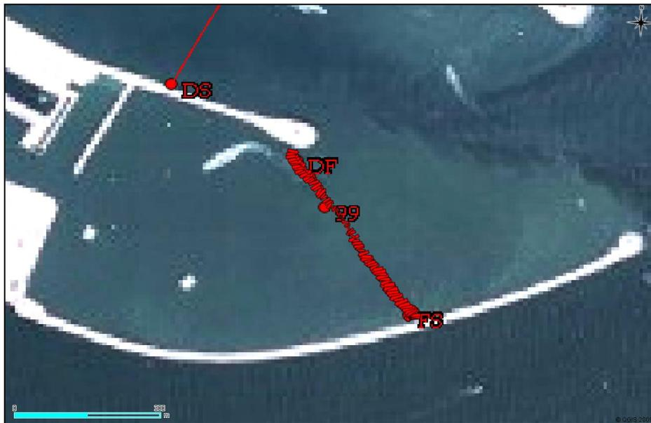
Figura 2.15. Vettori della velocità di corrente del vortice presso il bacino di evoluzione della conca di navigazione. Condizioni di marea calante. Transetto Ma07\_017r.000 del 21 luglio 2009 ore 13.07.
