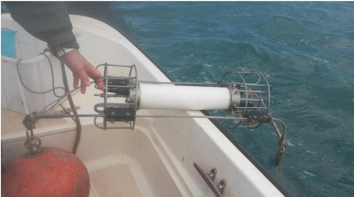
Figura 2.6. Sonda della stazione MAM prima (sopra) e dopo la pulizia (sotto).
