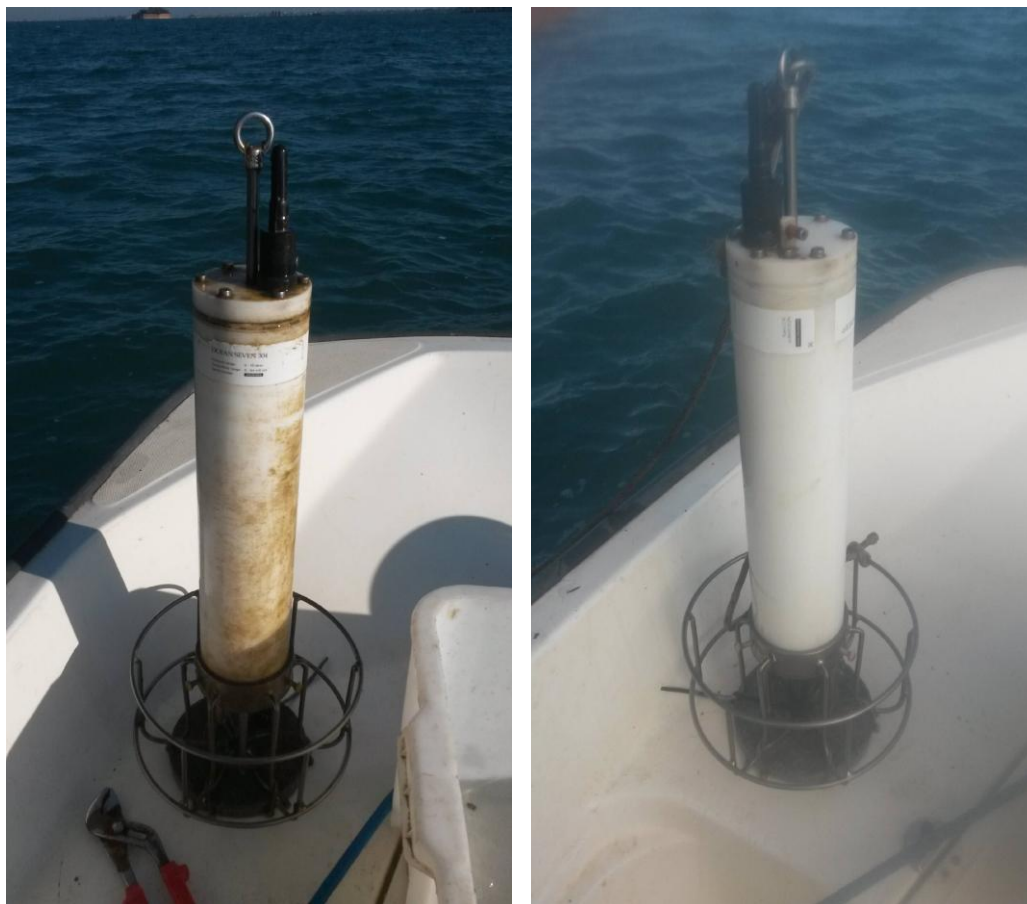
Figura 2.6. Sonda della stazione MAM prima (a sinistra) e dopo la pulizia (a destra)
