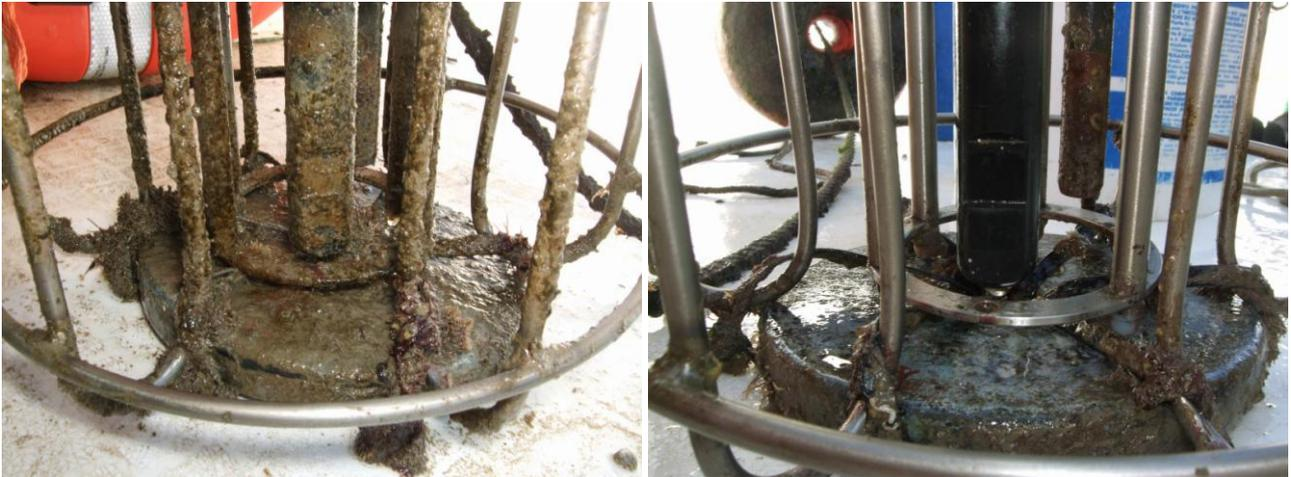
Figura 1.7. Stato della sonda ubicata nella stazione MAM prima e dopo le operazioni di pulizia (12 Ottobre 2010).
