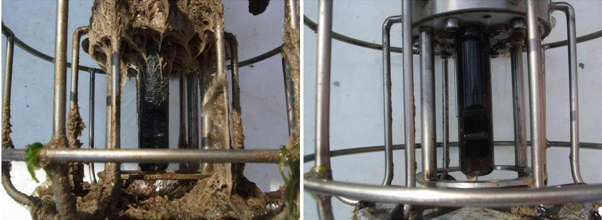
Figura 1.7. Stato della sonda prima e dopo le operazioni di pulizia.
