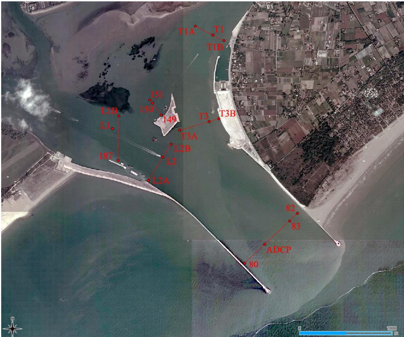
Figura 2.1. Immagine della bocca di Porto di Lido. Posizione degli estremi dei transetti e delle stazioni di acquisizione, lungo gli stessi transetti, dei profili verticali (T1 e T3 per il Canale di Treporti, L1 e L2 per il Canale di San Nicolò, 150 per il canale retrostante l'isola nuova, ADCP e 83 per la sezione ADCP fisso) durante la campagna di monitoraggio dei giorni 15, 16 e 17 aprile 2008. Le coordinate di questi punti sono riportate in Tabella 2.2.
