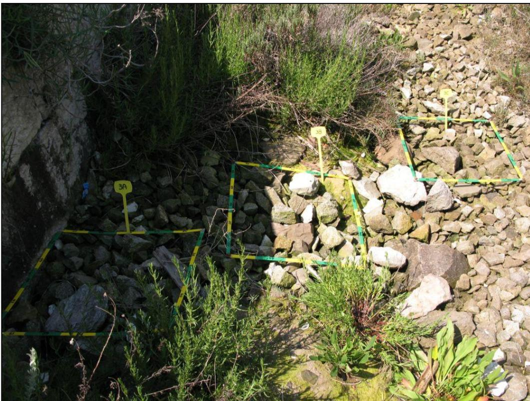
Foto 6.4 - Giugno 2012, Stazione 3: posizionamento dei tre campioni lungo un transetto rivolto dal margine della diga (campione A) verso la parte più infossata della pozza di sifonamento (campione C).
