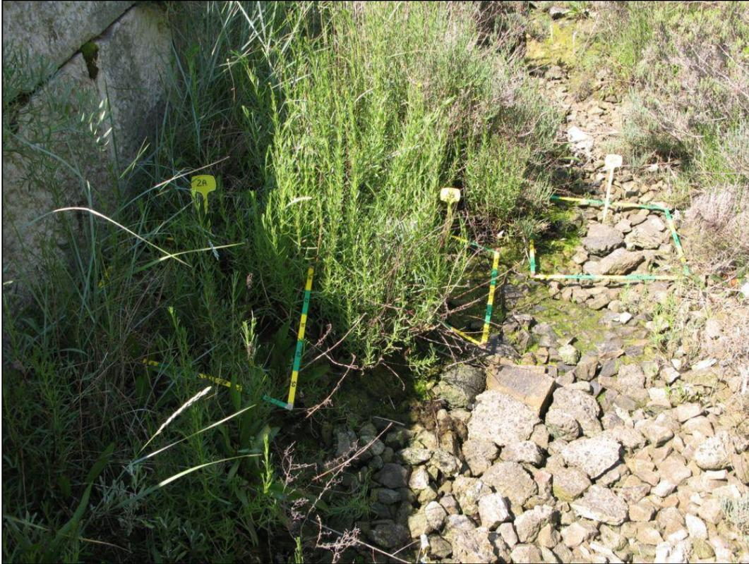
Foto 6.3 - Giugno 2012, Stazione 2: posizionamento dei tre campioni lungo un transetto rivolto dal margine della diga (campione A) verso la parte più infossata della pozza di sifonamento (campione C).
