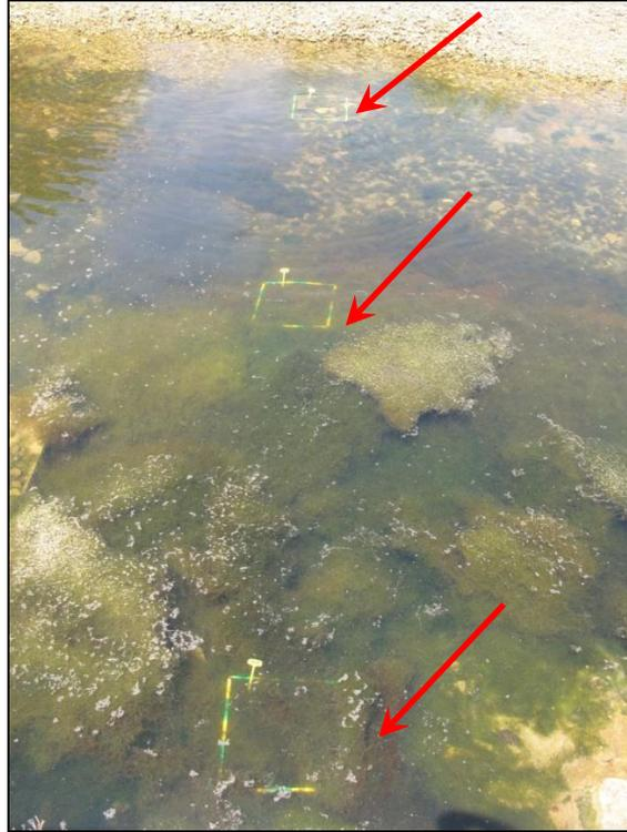
Foto 6.5 - Giugno 2012, Stazione 4: posizionamento dei tre campioni (indicati dalle frecce) lungo un transetto rivolto dal margine della diga (camp. A) verso il perimetro interno della pozza di sifonamento (camp. C).
